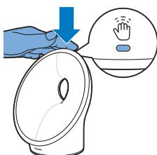
När väckningskurvan har avslutats (t.ex. den inställda maximala ljusintensiteten har uppnåtts) och larmljudet aktiveras kan du trycka längst upp på Sleep & Wake-Up Light för att använda snooze-funktionen.
