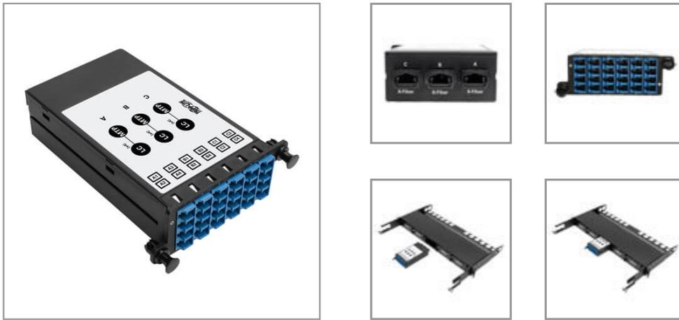
El casete de fibra monomodo se instala en bastidor de la serie N482 de Tripp Lite para conectar 12 cables de fibra LC dúplex con tres conexiones de 8 fibras MTP / MPO (APC) en aplicaciones de red de alta densidad.
