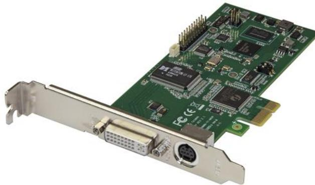
Cette carte d'acquisition vidéo PCIe vous permet d'enregistrer des vidéos HD 1080p et un flux audio stéréo 2 canaux (HDMI/RCA) sur votre système informatique. Grâce à ses nombreuses entrées vidéo, (HDMI, DVI, VGA et composante), cette carte d'acquisition tout-en-un est capable d'enregistrer vos contenus originaux à partir de pratiquement n'importe quel appareil.
