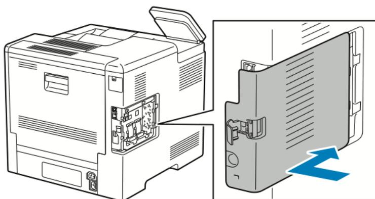
7. Per bloccare la copertura, ruotare la maniglia verso la parte anteriore della stampante, quindi spingere la maniglia finché non scatta in posizione di blocco.
