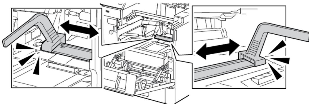
8. Riporre lo strumento di pulizia nell'apposito alloggiamento all'interno dello sportello anteriore.
