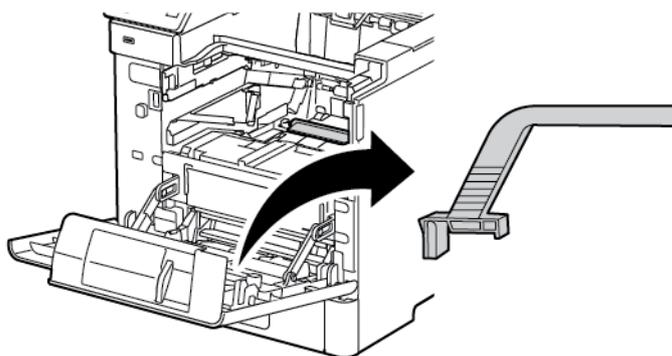
5. Rimuovere il tampone di pulizia dall'asta spingendo le linguette. Riciclare il tampone di pulizia usato in conformità alle normative locali.
