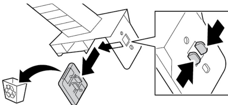
6. Se necessario, installare un nuovo tampone di pulizia sull'asta.
