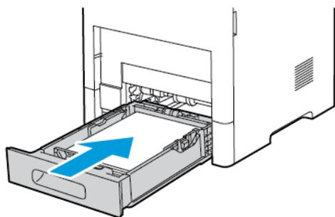
6. Inserire il vassoio bypass completamente nella stampante.
