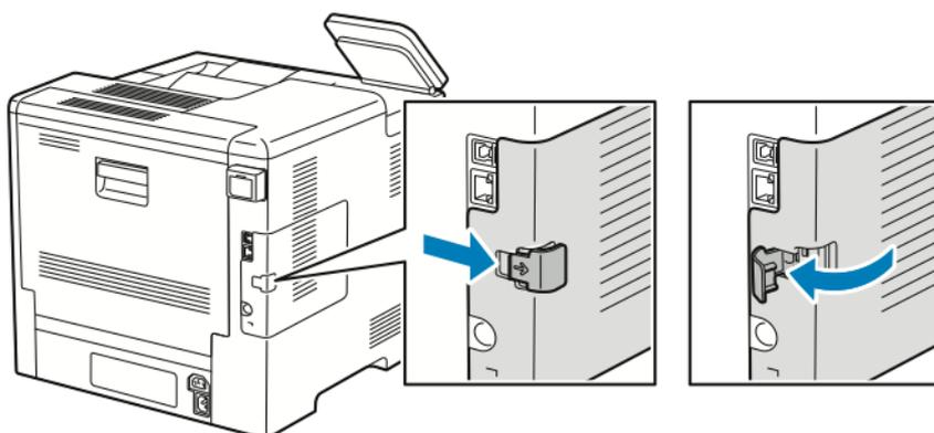
3. Para remover a tampa, deslize-a na direção da parte traseira da impressora e, em seguida, para fora dela.
