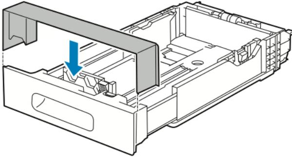
6. Coloque papel na bandeja antes de inseri-la de volta na impressora.
