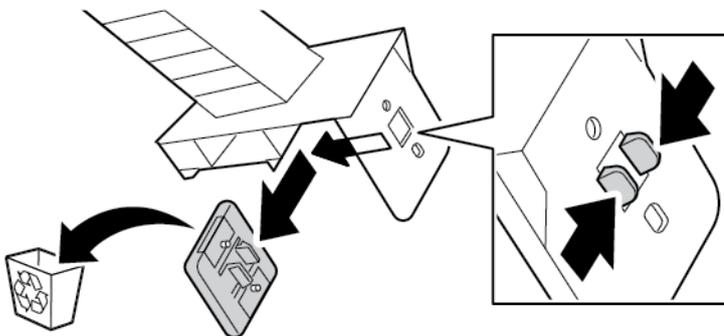
6. Se necessário, instale uma nova almofada de limpeza na ferramenta de limpeza.
