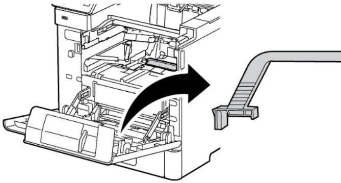
5. Retire a almofada de limpeza da ferramenta de limpeza, empurrando para dentro as duas abas. Recicle adequadamente a almofada de limpeza usada.
