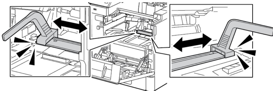
8. Substitua a ferramenta de limpeza em seu local de armazenamento dentro da porta dianteira.
