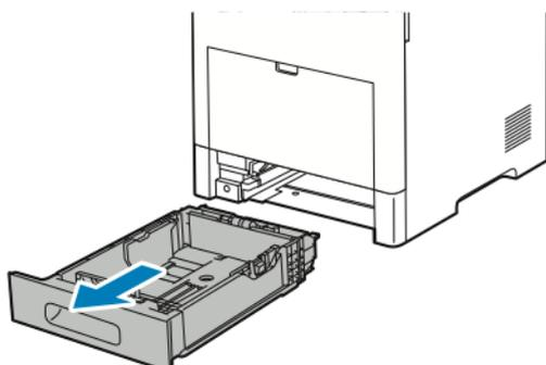
2. Ajuste as guias de comprimento e de largura do papel, conforme ilustrado.
