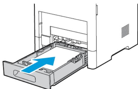
6. Coloque a Bandeja manual completamente na impressora.
