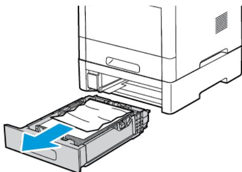
3. Remova qualquer papel amassado da bandeja e qualquer papel atolado restante na parte dianteira da impressora.
