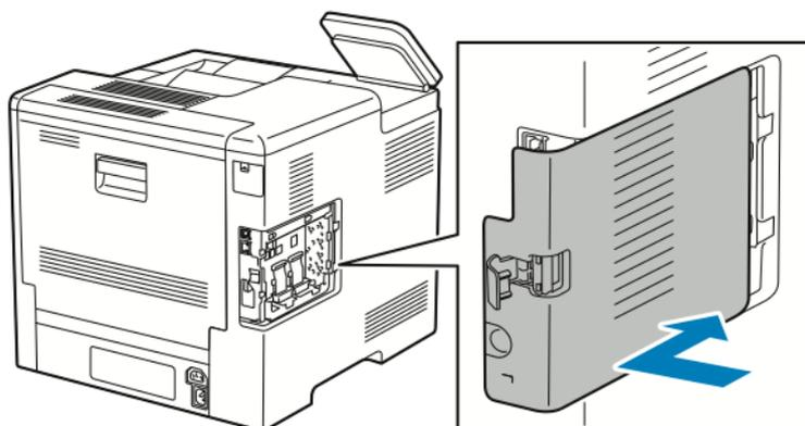
7. Para travar a tampa, gire a alça em direção à parte dianteira da impressora e empurre a alça até ela se encaixar na posição travada com um clique.
