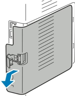
4. Dentro da impressora, empurre a alavanca de liberação na direção da frente da impressora. Mantenha a alavanca de liberação nessa posição enquanto puxa gentilmente o adaptador de rede sem fio para fora da impressora.
