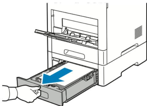
2. Para remover a bandeja, levante ligeiramente a dianteira e puxe-a para fora da impressora.
