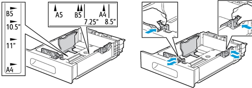
4. Coloque os envelopes nas bandejas com as abas fechadas e voltadas para baixo e com a borda curta em direção à impressora.
