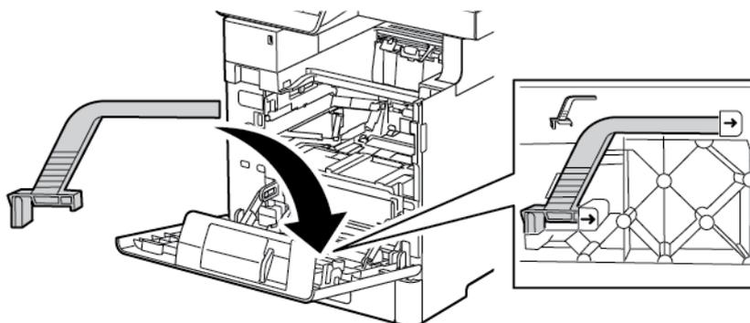
9. Enfoncez le module photorécepteur dans l'imprimante jusqu'à ce qu'il arrive en butée.
