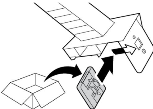
6. Si nécessaire, installez un nouveau tampon de nettoyage dans la tige de nettoyage.
