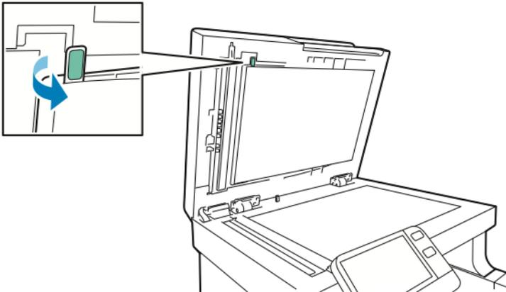
8. À l'aide d'un chiffon doux humecté d'eau, essuyez la vitre miroir, la bande plastique blanche et les rouleaux. Si vous avez du mal à enlever les salissures, humectez un chiffon doux avec une petite quantité de détergent neutre et essuyez les différentes parties de l'imprimante avec un chiffon doux.
