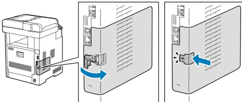
8. Branchez l'imprimante sur votre ordinateur au moyen d'un câble USB ou raccordez-la au réseau au moyen d'un câble Ethernet.
