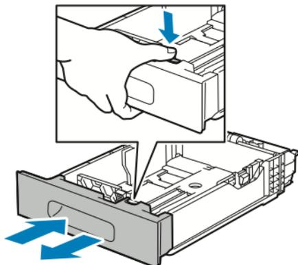
4. Pour préparer le magasin à recevoir un format plus long, tenez-le d'une main à l'arrière. De l'autre main, appuyez sur le levier de dégagement à l'avant du magasin, puis tirez les bords du magasin vers l'extérieur jusqu'à ce qu'ils s'enclenchent en position.
