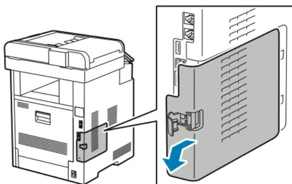
4. Mettez la main dans le châssis et poussez le levier de dégagement vers l'avant de l'imprimante. Maintenez le levier dans cette position pendant que vous sortez doucement l'adaptateur réseau sans fil de l'imprimante.
