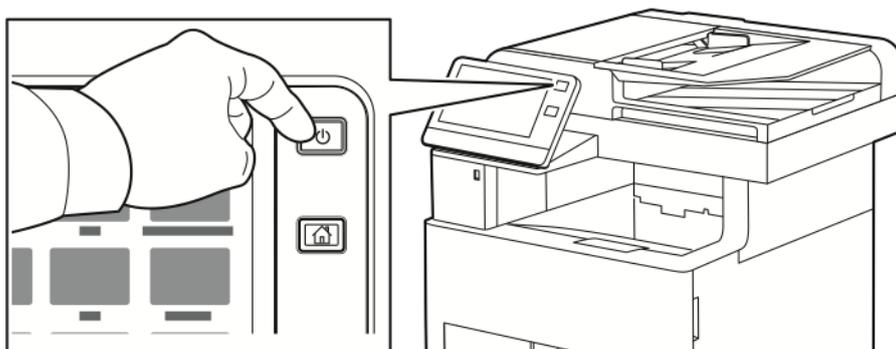
6. Configurez les paramètres Wi-Fi à partir du panneau de commande ou par l'intermédiaire du serveur Web intégré, si l'imprimante est connectée via Ethernet. Pour plus d'informations, reportez-vous à .
