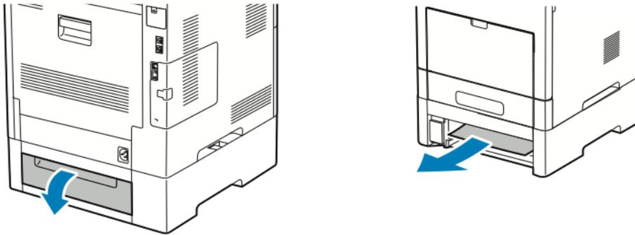
5. Réinsérez le magasin dans l'imprimante, puis poussez-le jusqu'à ce qu'il s'arrête.
