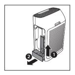
3 去除纳米云旋转式加湿滤网的所有 包装材料。
