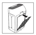
3 去除纳米级劲护滤网的所有包装 材料。
