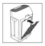
6 要重新安装后盖,请先将面板安装 到产品底部,然后朝产品方向推动 面板顶部。
