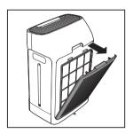
2 向下按两个固定夹,然后朝您自己的方向拉动预过滤网。
