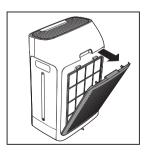
2 要卸下预过滤网,请向下按两个固定夹,然后朝您自己的方向拉动过滤网。
