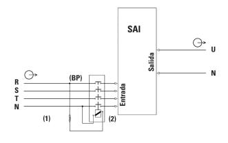
«Backfeed protection» connection for TWIN PRO2.
