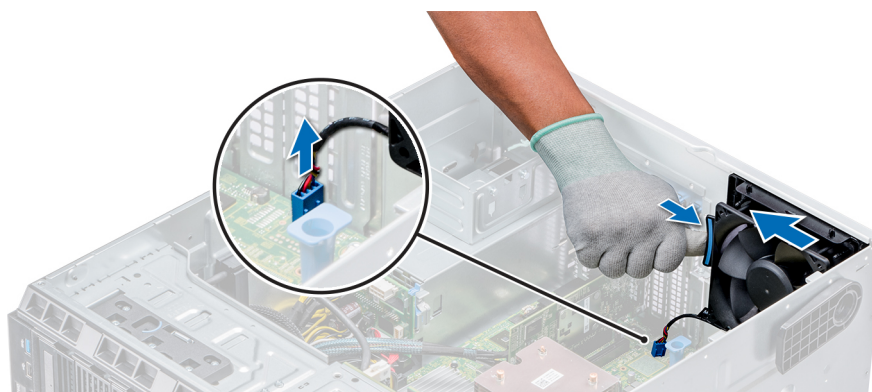
Ilustración 56. Extracción del ventilador de refrigeración interno
