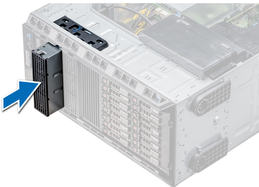
Ilustración 38. Instalación de la unidad óptica o de cinta de relleno
