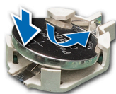
Ilustración 88. Instalación de la batería del sistema
