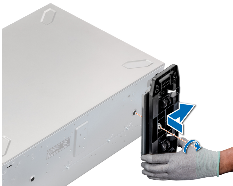
Ilustración 22. Instalación de las ruedas giratorias
