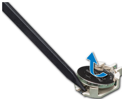
Ilustración 87. Extracción de la batería del sistema
