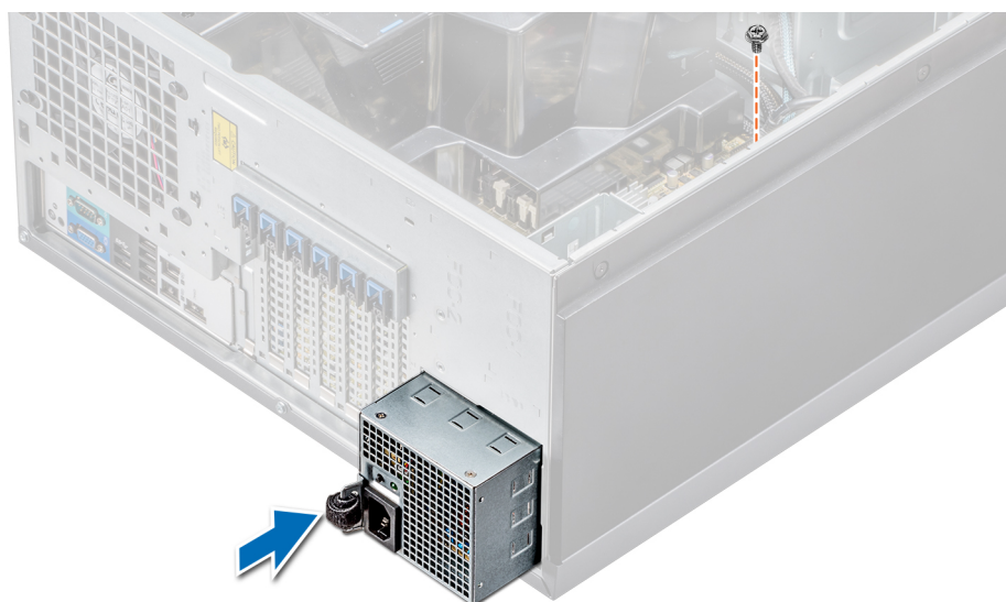
Ilustración 84. Instalación de una PSU cableada
