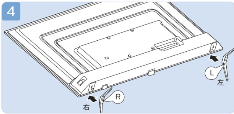
\*将底座按照图示对齐放置(注意区分左右支撑), R、L在底座上有标识。
