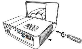
3. Retire la cubierta de la lámpara del proyector.
