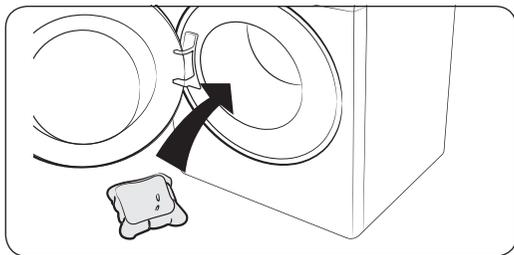
1. Legen Sie die Kapsel in der Nähe der Rückwand auf den Boden der leeren Trommel.
