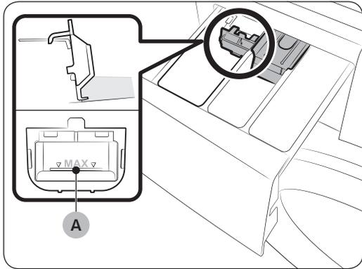
Setzen Sie zunächst den Flüssigwaschmitteleinsatz in das **II Hauptwaschmittelfach** ein. Füllen Sie anschließend Flüssigwaschmittel in das Fach. Überschreiten Sie dabei jedoch nicht die **maximale Einfüllhöhe (A)**.
