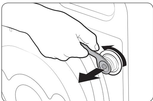
Entfernen Sie das gesamte Verpackungsmaterial sowie alle Transportsicherungen.
