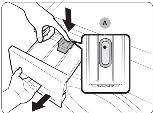
1. Ziehen Sie den Waschmittelbehälter heraus, während Sie gleichzeitig den **Entriegelungshebel (A)** im Behälter herunterdrücken.
