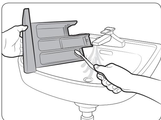
3. Reinigen Sie die Komponenten des Waschmittelbehälters unter fließendem Wasser mit einer weichen Bürste.
