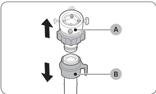
Schließen Sie den Frischwasserschlauch an den Wasserhahn an.
