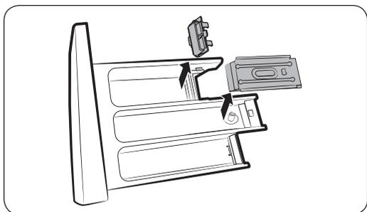
2. Entfernen Sie den Entriegelungshebel und den Flüssigwaschmitteleinsatz aus dem Waschmittelbehälter.
