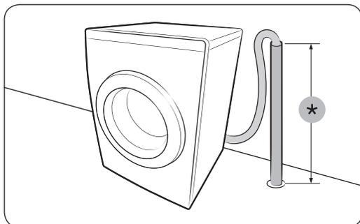
Schlauch in ein Abflussrohr einleiten
