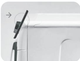
Ukoliko ne znate gdje je smještena NFC antena, laganim kružnim pokretima pomičite smartphone preko Smart Touch loga dok aplikacija ne potvrdi spajanje. Za uspješan prijenos podataka, ključno je NEPREKIDNO DRŽATI SMARTPHONE NA UPRAVLJAČKOJ PLOČI UREĐAJA TIJEKOM CIJELOG POSTUPKA (NEKOLIKO SEKUNDI); poruka na uređaju će vas informirati o pravilnom spajanju i kada je moguće udaljiti smartphone..
