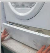
2. Okrenite dvije preklopne poluge u smjeru suprotnom od kazaljke na satu i povucite kondenzator.
