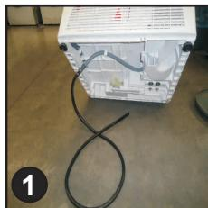
2. Ο σωλήνας που χρησιμοποιείται στα δεξιά (δείτε εικόνα). Ένας γκρι εύκαμπτος σωλήνας συνδέεται με τη γέφυρα στα αριστερά της συσκευής. Χρησιμοποιήστε μια πένσα για να ανοίξετε το κλιπ συγκράτησης του σωλήνα που βρίσκεται στη γέφυρα.
