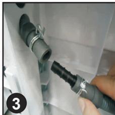
4. Učvrstite crnu cijev iz kompleta za instalaciju pomoću spojnice i obujmice na cijev izvučenu sa spoja s mostom.
