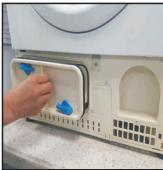
4. Krpom uklonite prašinu i ostatke vlakana, a rešetke kondenzatora potom operite pod mlazom vode.
