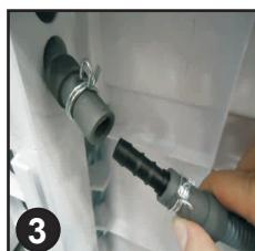
4. Συνδέστε τον μαύρο εύκαμπτο σωλήνα που περιέχεται στη συσκευή σία (χρησιμοποιώντας τον σύνδεσμο και τα κλιπ συγκράτησης που παρέχονται) στη θέση του παλιού σωλήνα που αφαιρέσατε από την γέφυρα.
