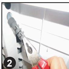
3. Izvucite cijev iz spoja s mostom.
