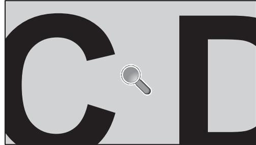
L'utilisation du bouton SET/POINT ZOOM de la télécommande permet d'agrandir une partie de l'image. Appuyez sur le bouton CH+/- pour effectuer un zoom avant ou arrière. L'image peut être agrandie jusqu'à 10 fois.
