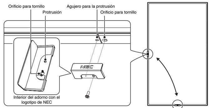
**AVISO:** No use ningún otro tornillo para colocar el adorno del monitor.
