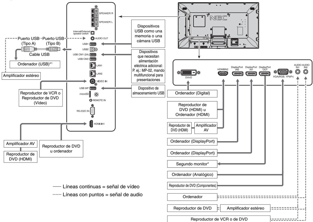
\*: Si hay varios monitores conectados en cadena existe un límite para los monitores conectables.
