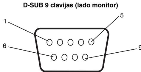
Este monitor LCD utiliza líneas RXD, TXD y GND para el control de RS-232C.
