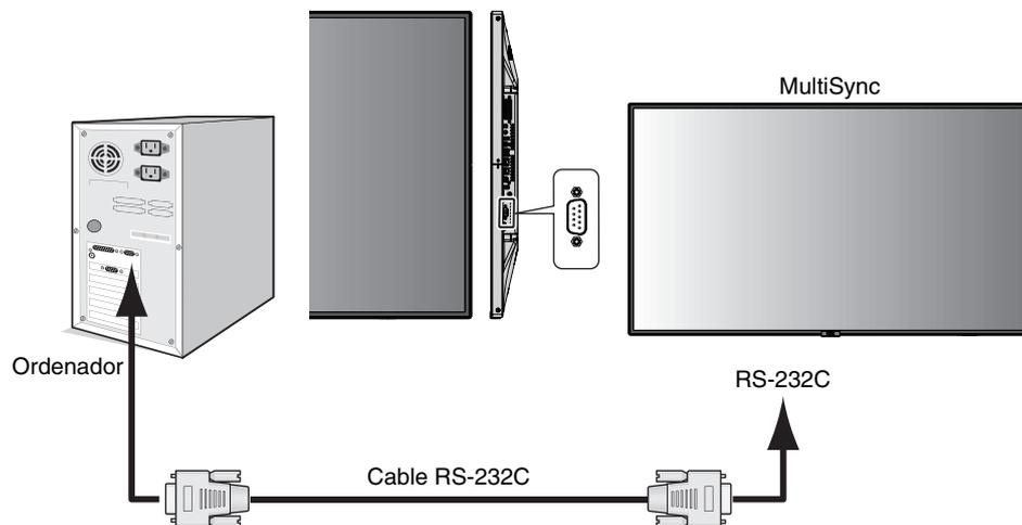
**NOTA:** Si su ordenador sólo tiene un conector de puerto serie de 25 clavijas, es necesario un adaptador de puerto serie de 25 clavijas. Póngase en contacto con su proveedor si desea más información. Para ver la asignación de las clavijas consulte "2) Entrada/salida RS-232C" en la página siguiente.
