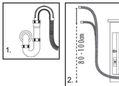
⚠ Il tubo di scarico non deve essere immerso nell'acqua, deve essere fissato saldamente e mantenuto sempre integro. Se il tubo di scarico viene posizionato per terra o a un'altezza inferiore a 80 cm, la lavatrice continuerà a scaricare l'acqua mentre viene riempita (autosifonaggio). Non aggiungere prolungamenti al tubo di scarico. Se necessario, contattare il servizio di assistenza post-vendita.
