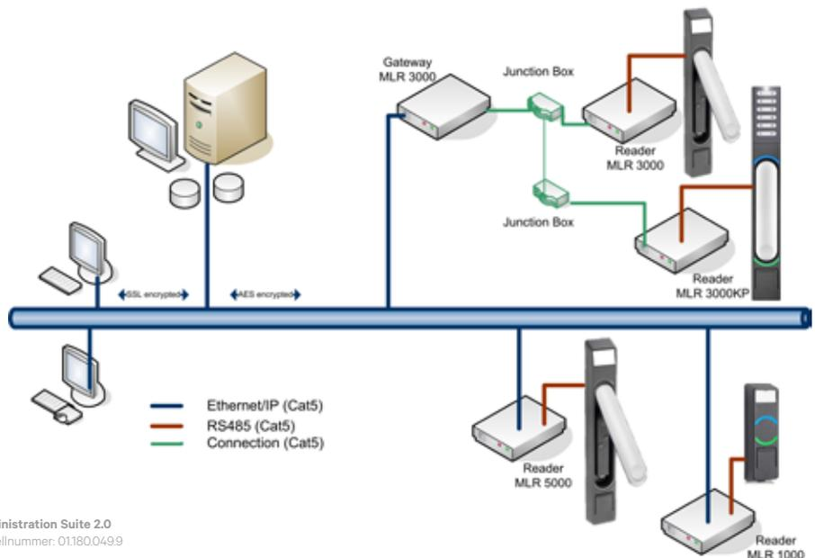
Für die Anbindung von Server- oder Netzwerkschränken an das Transponderkartensystem eignen sich die Hebel der Serien MLR 3000 und MLR 5000. Mit den mechatronischen Schwenkhebeln der Serie E-LINE by DIRAK und der Administration Suite Software erhalten Sie eine komfortable und zuverlässige Möglichkeit der Zugangsüberwachung zum Daten- oder Serverschrank. Sicherheitsverantwortliche können von einem PC die Zugangsrechte mit der Administration Suite Software bequem kontrollieren und steuern.
