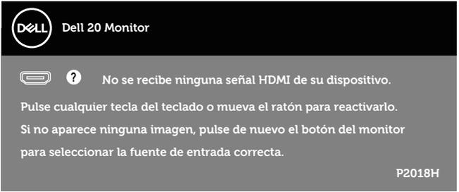
Si el cable VGA, HDMI o DP no está conectado, aparecerá un cuadro de diálogo flotante, tal y como se muestra a continuación. El monitor entrará en el modo de ahorro de energía después de 4 minutos si permanece en este estado.
