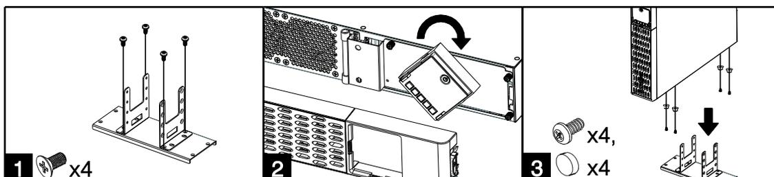
1. Befestigen Sie die Halterungen mit den mitgelieferten M4-Flachkopfschrauben an der Grundplatte.
