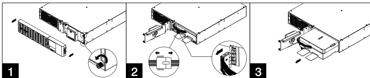
1. Entfernen Sie die Frontblende und schrauben Sie die Rändelschrauben an der werkzeuglosen Batteriezugangstür ab und öffnen Sie dann die Tür. Hinweis: Rändelschrauben sind fest an der Tür angebracht, entfernen Sie sie nicht von der Metallabdeckung.
