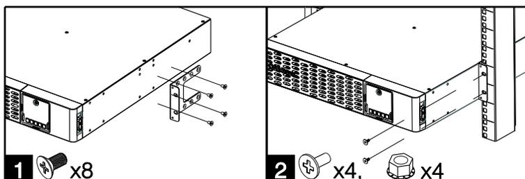
1. Befestigen Sie die Halterungen mit den mitgelieferten M5 Flachkopfschrauben.
