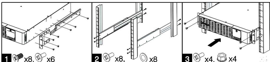
1. Verwenden Sie die mitgelieferten M5-Flachkopfschrauben, um die Halterungen und mitgelieferten M5-Flachkopfschrauben für hängende Halterungen zu befestigen.
