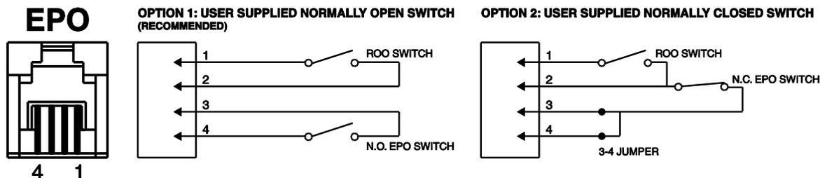
3. Stellen Sie nach der Verdrahtung sicher, dass der externe EPO / ROO-Schalter nicht aktiviert ist, um den USV-Ausgang zu aktivieren.
