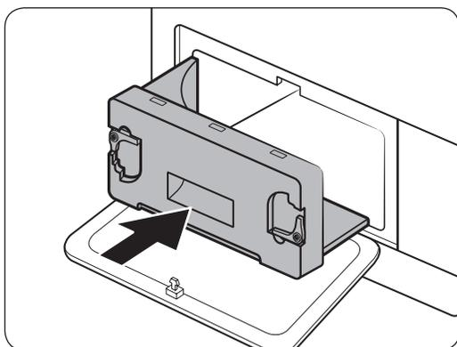
6. Rimontare il coperchio interno nella sua posizione originale e chiudere le leve di fissaggio.
