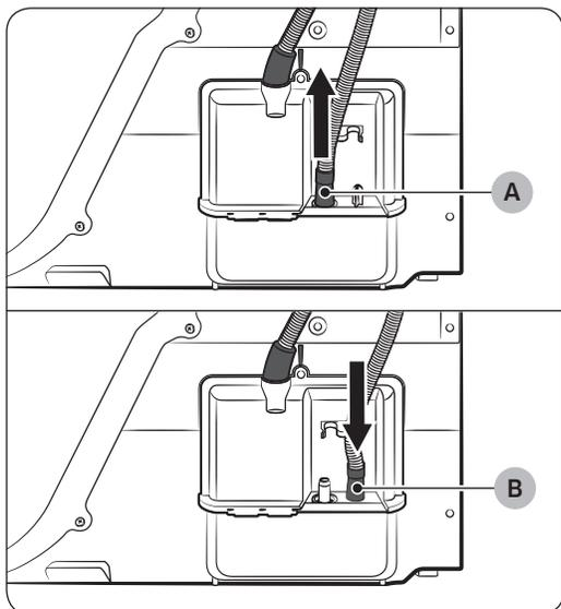
1. Rimuovere il tubo di scarico dal foro (A), ed inserirlo nel foro (B).
