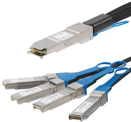
Der QSFP4SFPPC1M ist ein MSA- konformes QSFP+-Twinax-Direktanschlusskabel. Es wurde entwickelt, programmiert und getestet, um 40 G-Netzwerkgeräte mit 10G-kompatiblen Servern oder Routern zu verbinden. Dieses passive Twinaxialkabel verbindet einen einzelnen QSFP+-Anschluss mit vier 10G-SFP+-Anschlüssen und ist vollständig Hot-Plug-fähig, wodurch Upgrades und Austauschvorgänge mit nur minimalen Netzwerkunterbrechungen nahtlos durchgeführt werden können.
