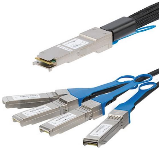
El modelo QSFP4SFPPC2M es un cable multiconector QSFP+ Twinax, con conexión directa, compatible con MSA. Está diseñado, programado y probado para su funcionamiento como puente con equipos de red a 40G con enrutadores y comutadores compatibles con 10G. Este cable Twinax (Twin axial) pasivo conecta un solo puerto QSFP+ a cuatro puertos SFP+ 10G, y permite el intercambio en caliente, lo cual facilita las actualizaciones y reemplazos, ya que minimiza las interrupciones de conexión en red.
