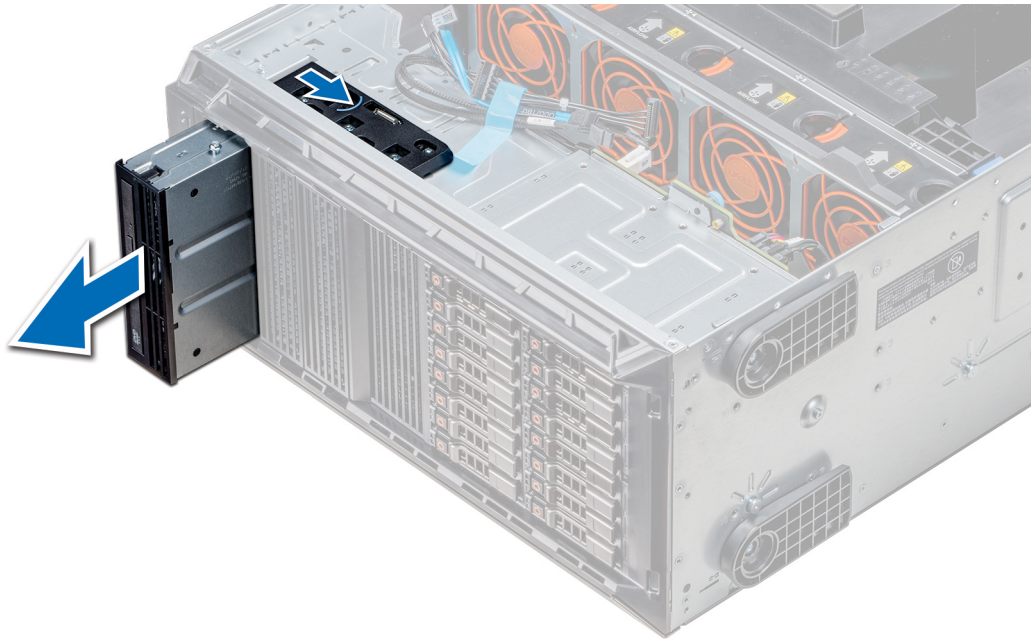
Figure 56. Retrait du bâti de lecteur optique ou du lecteur de bande
