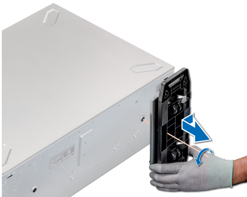
Figure 24. Retrait des roulettes
