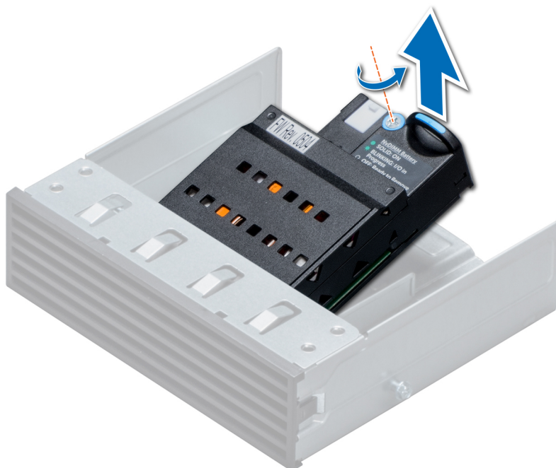
Figure 60. Retrait de la pile du module NVDIMM-N
