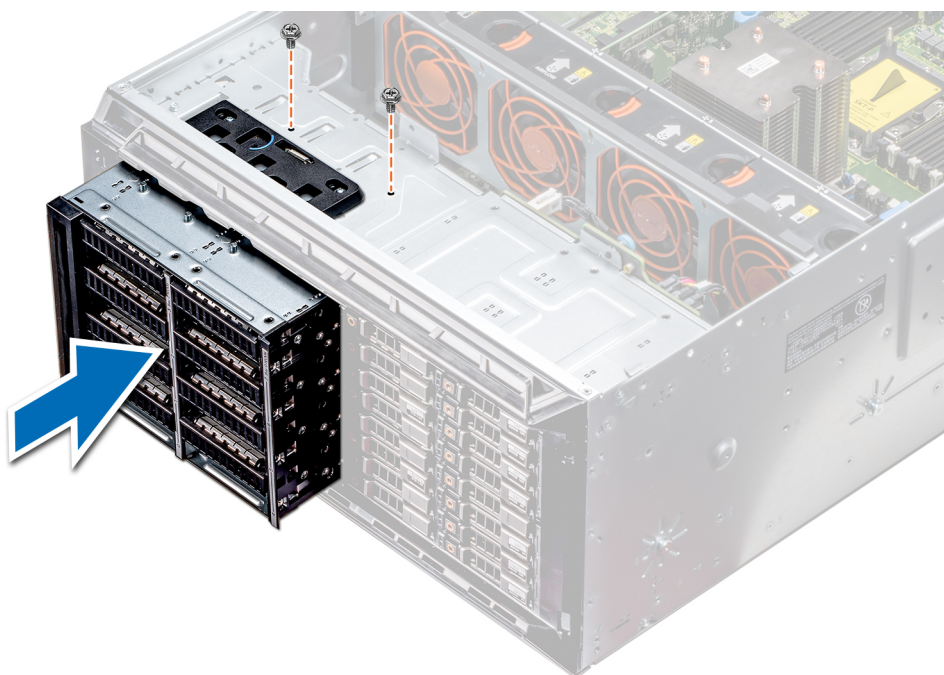
Figure 53. Installation d'une baie de lecteur NVMe ou d'une baie FlexBay
