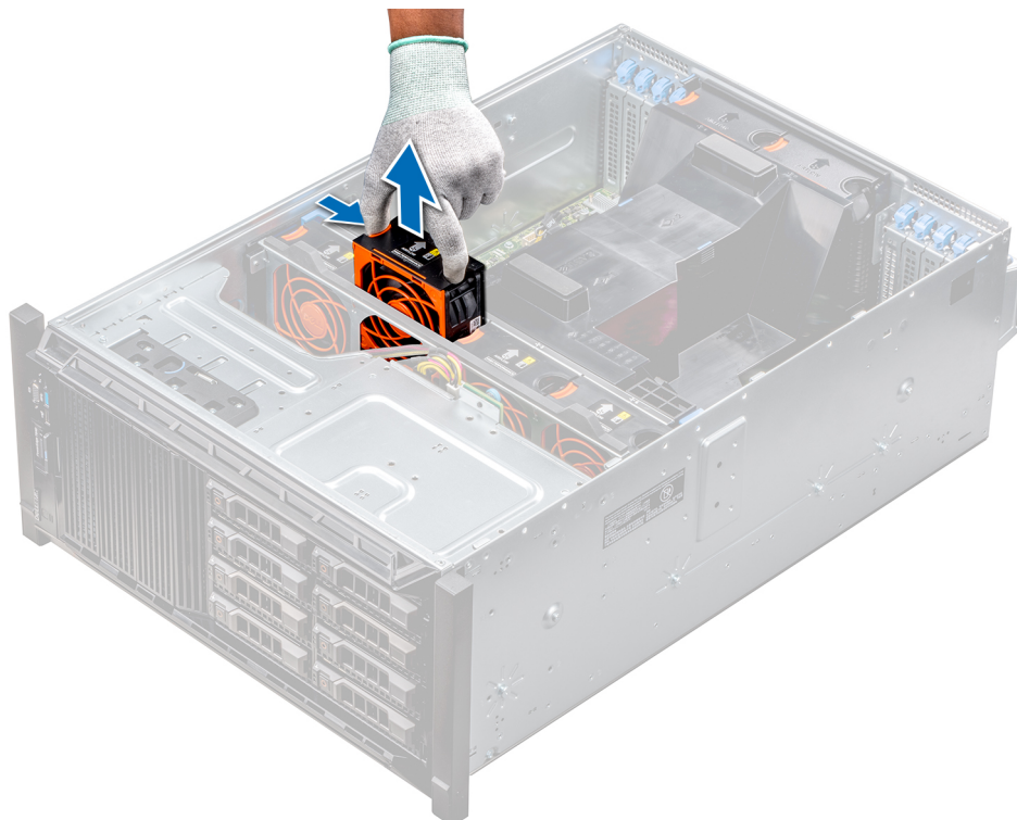
Abbildung 46. Entfernen eines mittleren Kühlungsüfters
