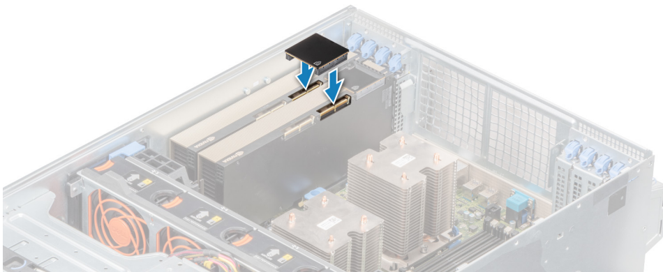
Ilustración 86. Instalación del puente NVLink opcional
