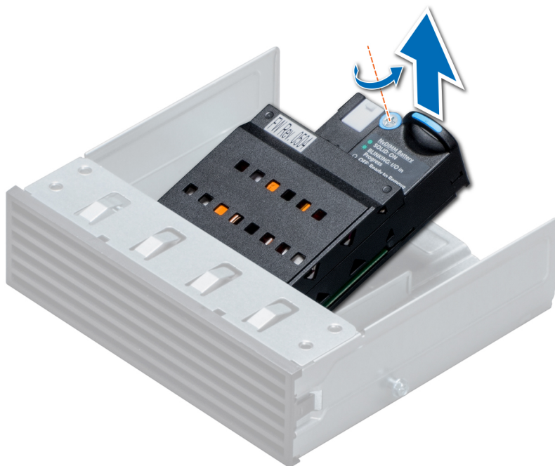
Ilustración 60. Extracción de la batería NVDIMM-N
