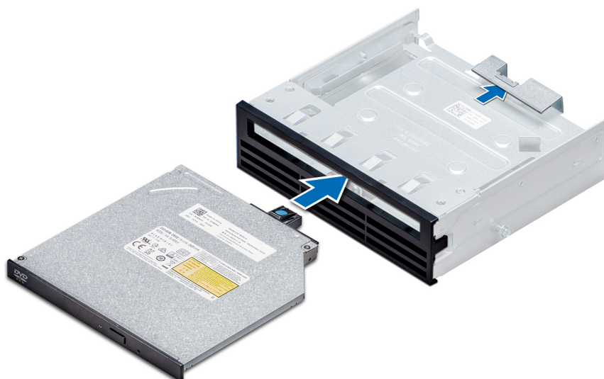
Ilustración 59. Instalación de la unidad óptica reducida de relleno
