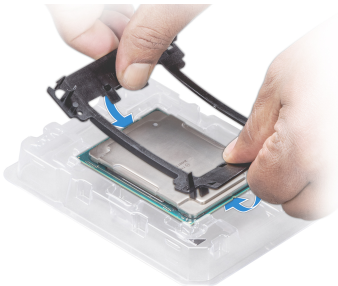
Ilustración 68. Instalación del soporte del procesador
