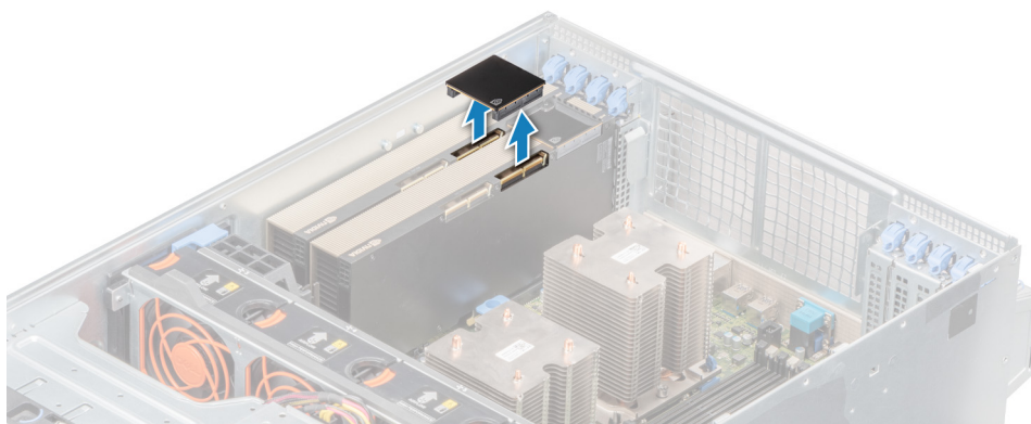
Ilustración 84. Extracción del puente NVLink opcional
