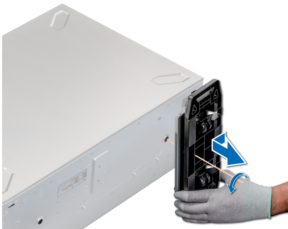
Ilustración 24. Extracción de las ruedas giratorias
