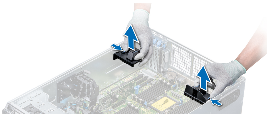
Ilustración 72. Extracción de portatarjetas de expansión
