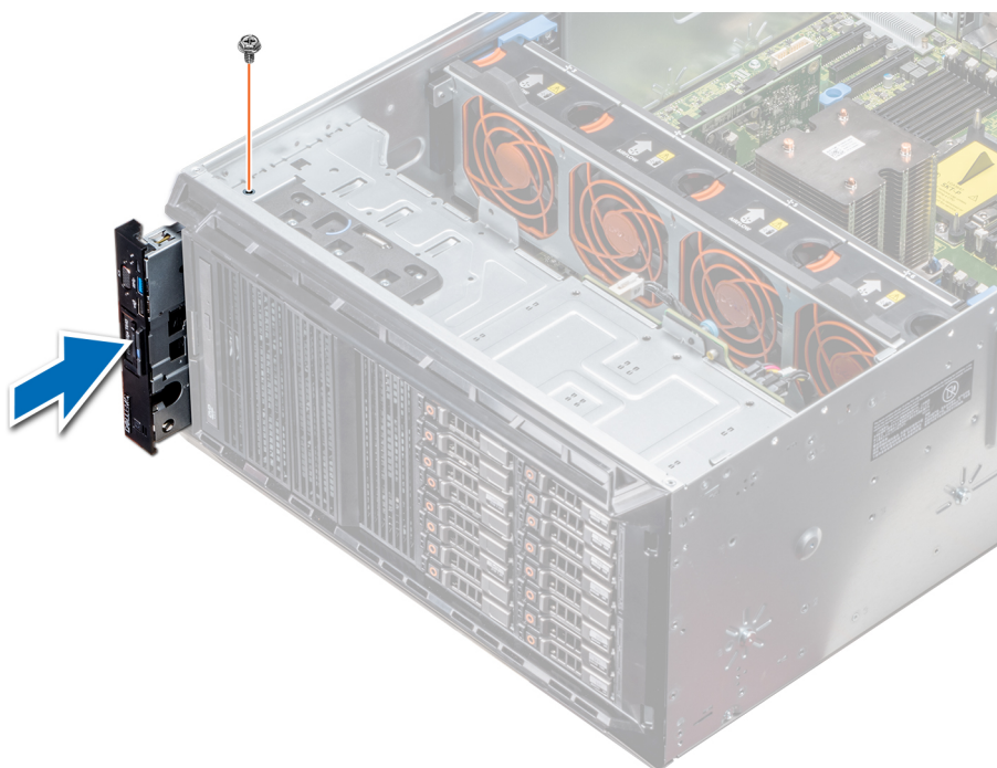
Ilustración 116. Instalación del ensamblaje del panel de control
