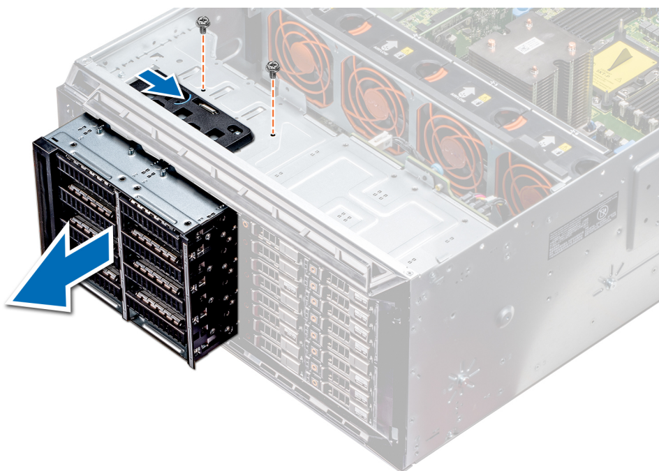
Ilustración 52. Extracción de un compartimento para unidades NVMe o un compartimento flexible
