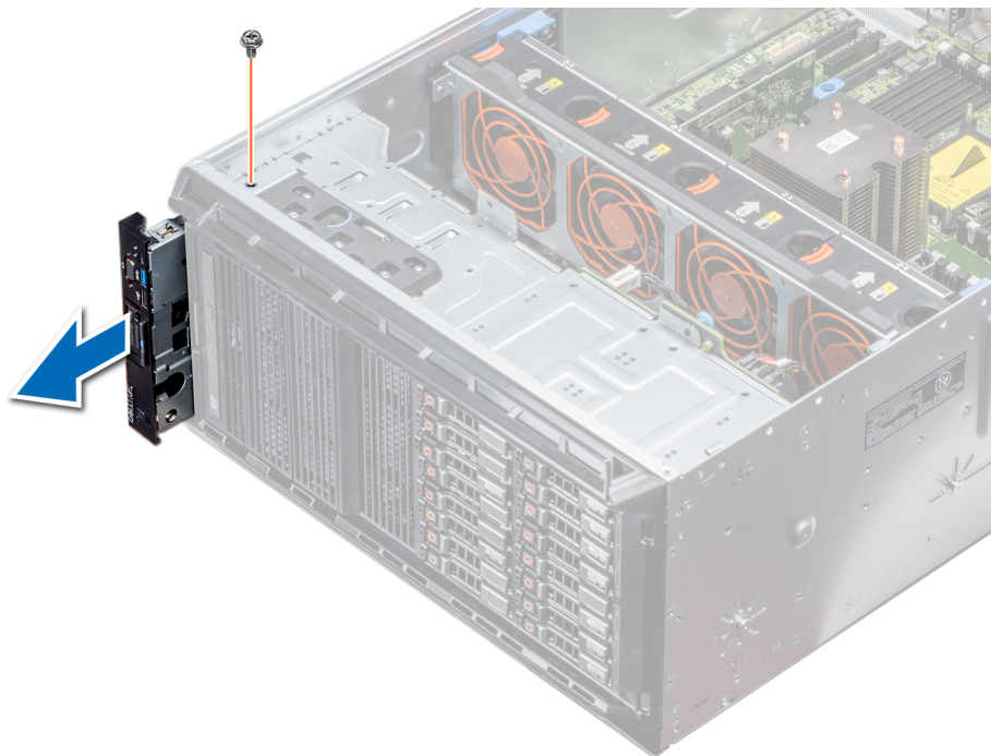
Ilustración 113. Extracción del ensamblaje del panel de control
