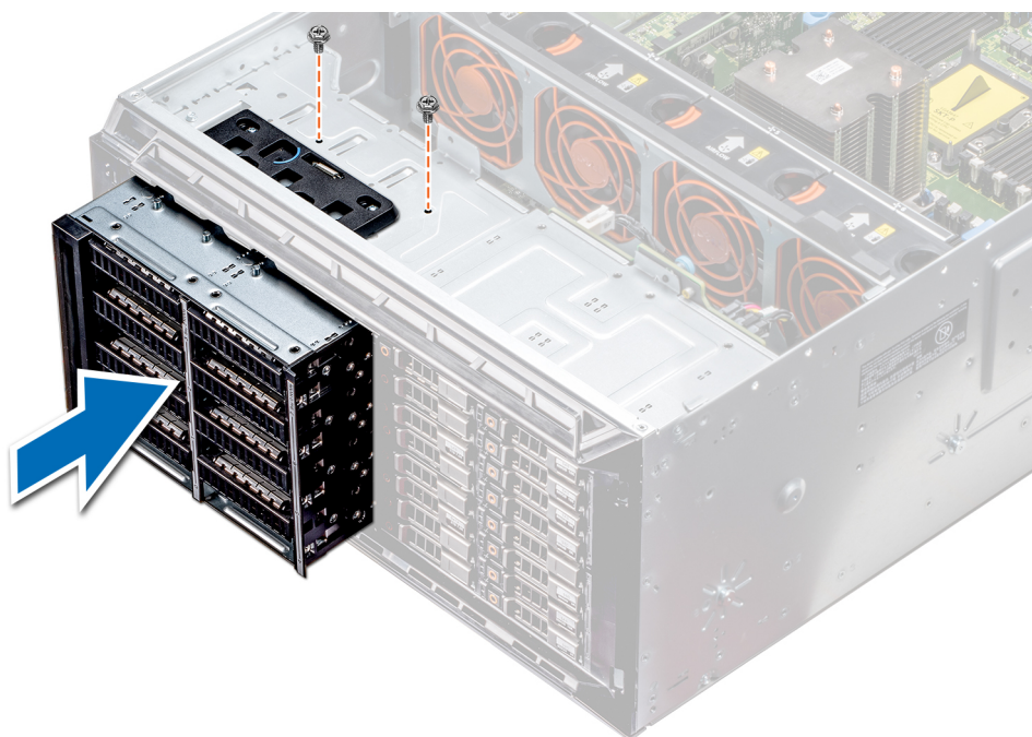
Ilustración 53. Instalación de un compartimento para unidades NVMe o Flexbay
