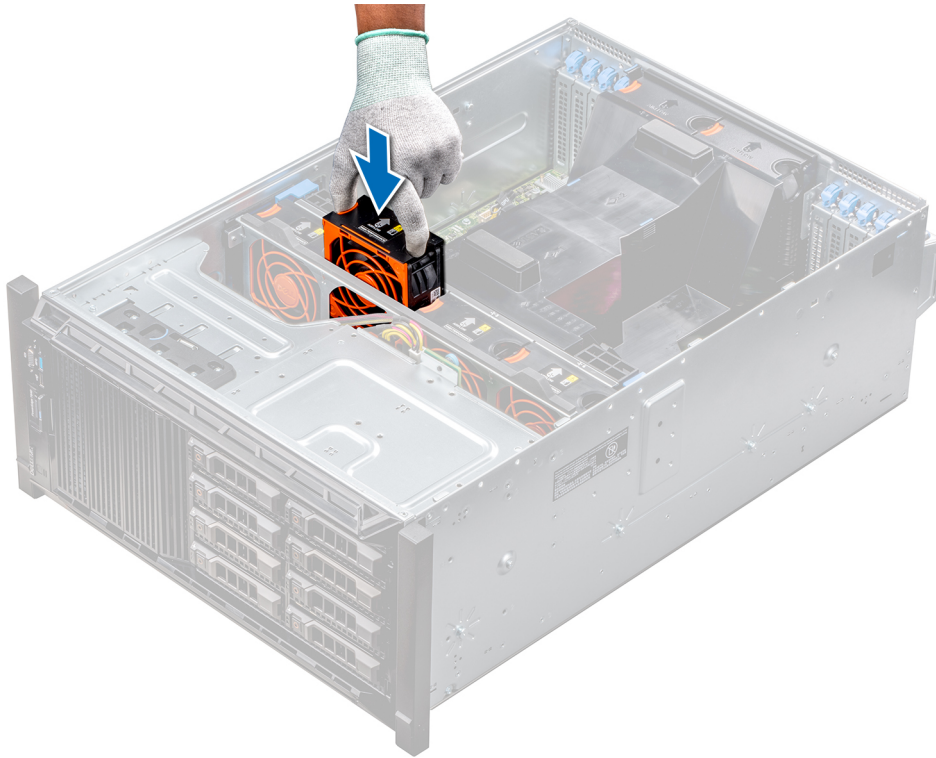
Ilustración 47. Instalación de un ventilador de refrigeración intermedio
