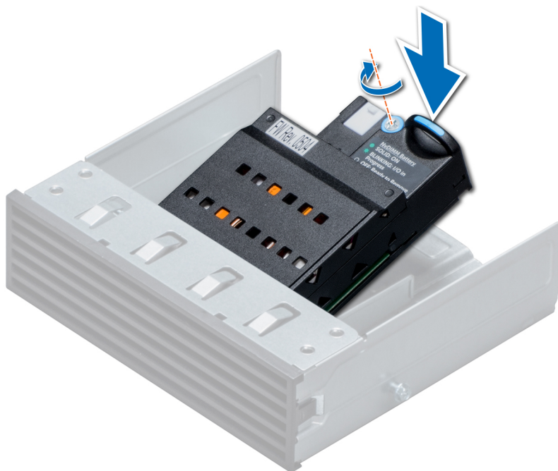
Ilustración 61. Instalación de la batería NVDIMM-N
