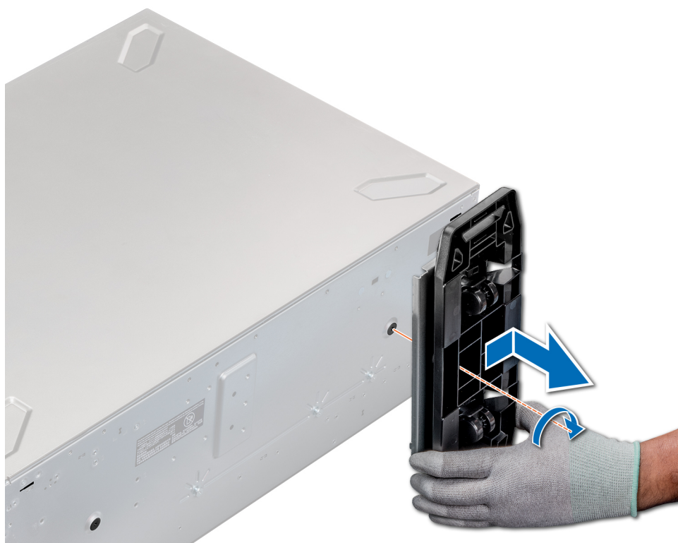
Ilustración 25. Instalación de las ruedas giratorias
