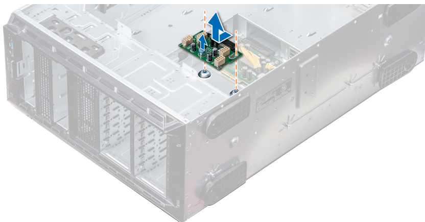
Ilustración 123. Extracción de la placa mediadora de alimentación GPU
