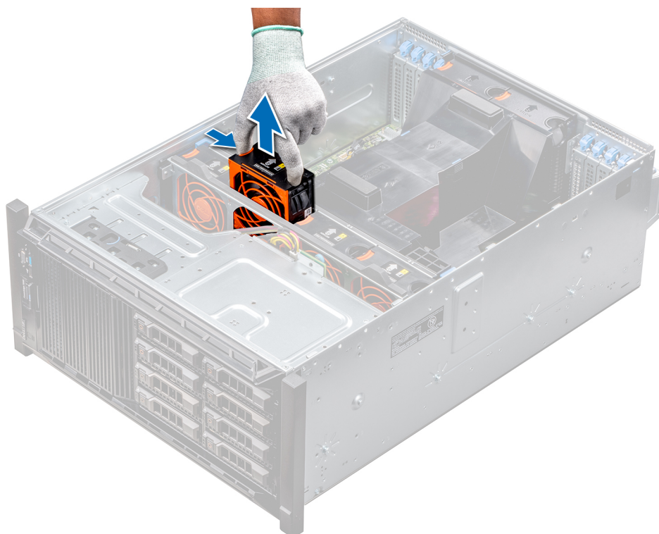
Ilustración 46. Extracción de un ventilador de refrigeración intermedio
