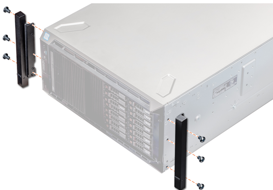
Ilustración 129. Instalación de las orejas del sistema
