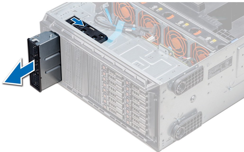
Ilustración 54. Extracción de la unidad óptica o de cinta
