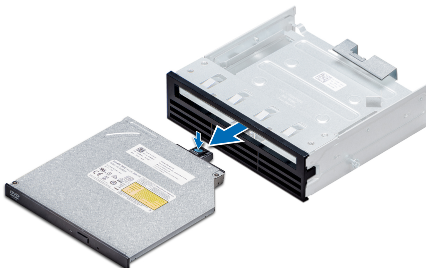
Ilustración 58. Extracción de la unidad óptica reducida de relleno
