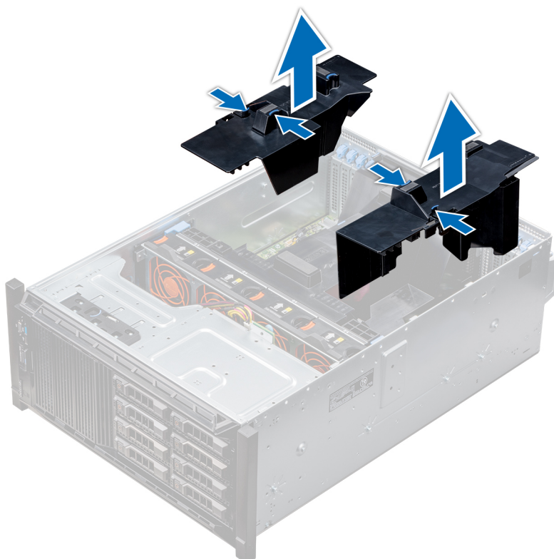
Ilustración 42. Extracción de las cubiertas para flujo de aire de GPU opcionales
