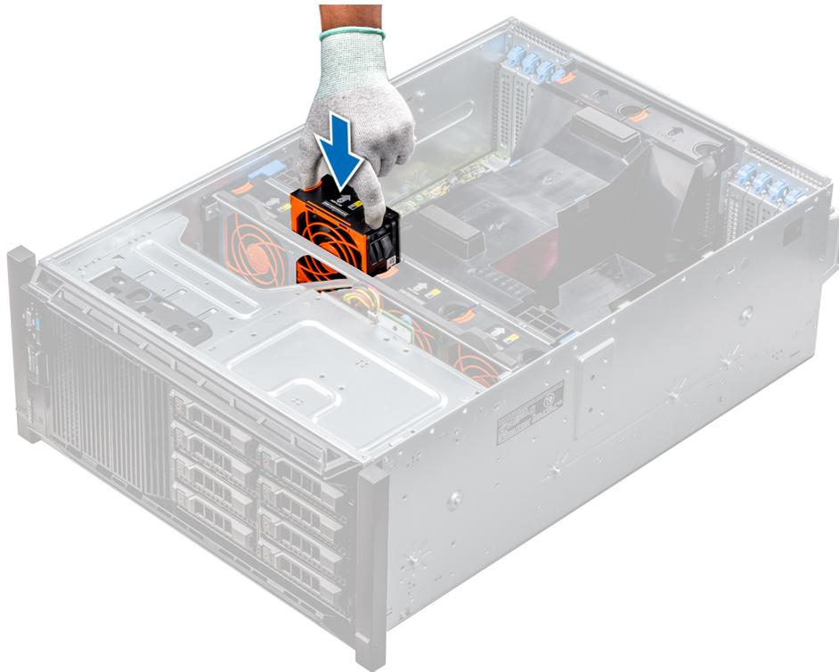
Figure 41. Installing a cooling fan
