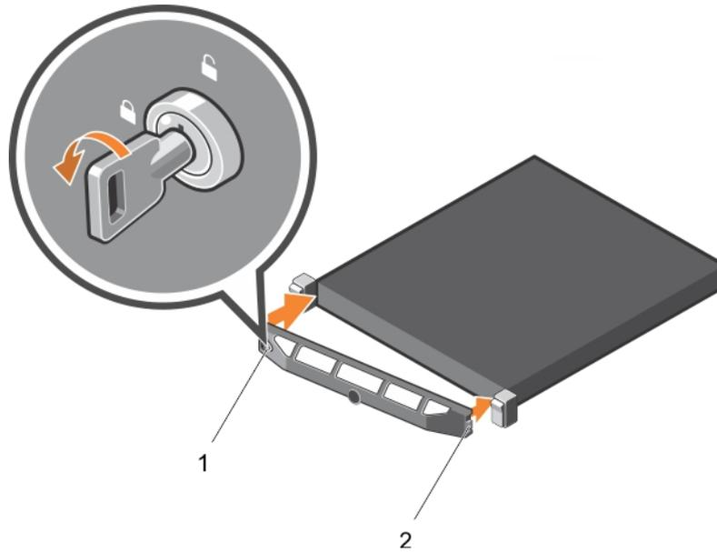
**Figure 10. Installing the optional front bezel**
