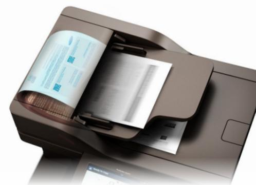
Le chargeur de documents Dual-Scan numérise les deux faces d'un document simultanément. Il est ainsi capable de numériser jusqu'à 60 images par minute (ipm), vous permettant de numériser et d'archiver tous vos documents plus rapidement.
