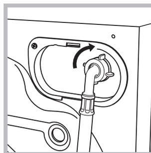
2. Collegare il tubo di alimentazione alla lavasciuga avvitandolo all'apposita presa d'acqua, nella parte posteriore in alto a destra (vedi figura).
