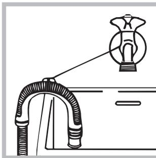
In alternativa, appoggiare il tubo di scarico al bordo di un lavandino o di una vasca, legando la guida (acquistabile presso il servizio assistenza) al rubinetto (vedi figura). L'estremità libera del tubo di scarico
