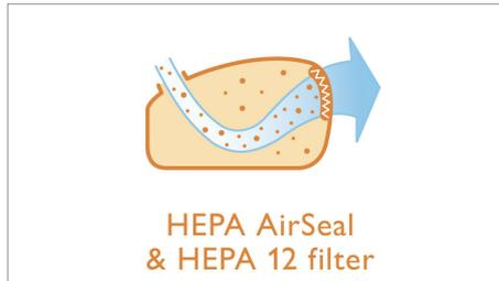
Questo aspirapolvere è stato progettato in modo che l'aria che lo attraversa passi all'interno del filtro lavabile HEPA 12 (filtraggio al 99,5%) prima di fuoriuscire. Nulla può sfuggire!
