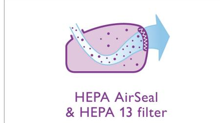
Este aspirador de Philips ha sido diseñado de tal forma que todo el aire aspirado pasa por el filtro lavable HEPA 13 (filtra el 99,95% de las partículas) antes de que salga de nuevo al exterior y sin que escape nada.
