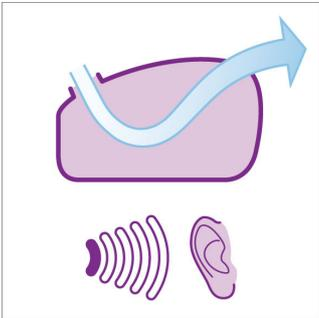
Se ha mejorado el canal de aire para garantizar que el aire se deslice suavemente y reducir así el ruido. Además, se ha desarrollado una suspensión del motor especial para reducir las vibraciones al mínimo.
