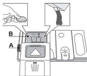
1. Per il dosaggio corretto del detersivo fare riferimento ai dati sopra riportati. La vaschetta **B** contiene indicatori di livello per facilitare il dosaggio del detersivo.
