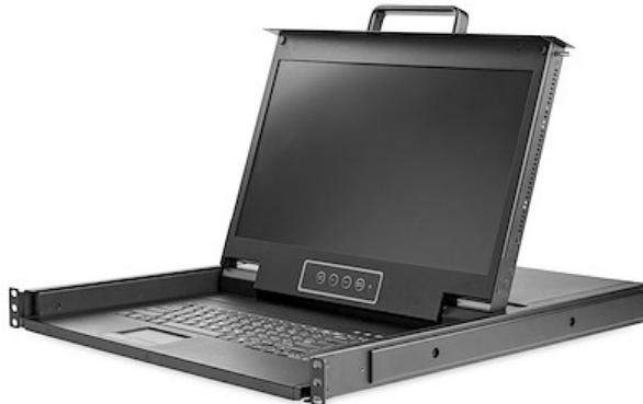
Esta consola KVM de alta definición para montaje en rack ofrece, además de un control centralizado de su PC o de docenas de servidores, un fácil acceso y visibilidad de su sistema mientras está montado en un rack o armario de servidores. Se conecta a sus servidores a través de un conmutador KVM independiente (se vende por separado), la consola LCD se instala en 1U de espacio de rack, por lo que proporciona una solución de espacio eficiente para el control completo de la consola.
