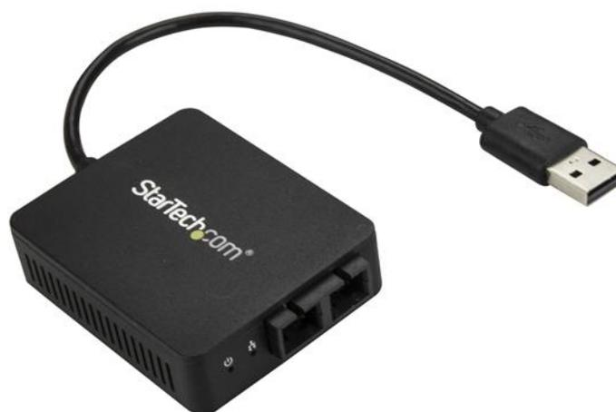
Ce convertisseur USB vers fibre optique vous permet d'utiliser le port USB 2.0 (Type-A) de votre ordinateur portable ou tablette pour bénéficier d'une connexion réseau à fibre optique sécurisée. Compatible Mac et Windows®, l'adaptateur réseau fournit une connexion réseau Ethernet 100 Mb/s et un transceiver optique 100Base-FX SC.
