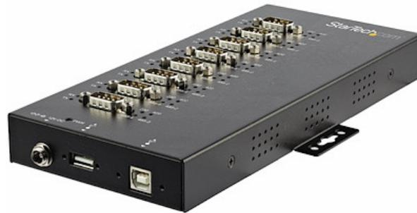
Permite agregar de manera fácil y rápida puertos COM adicionales a un ordenador portátil o de sobremesa. Este adaptador USB a serie RS232/422/485 le permite conectarse a sus dispositivos serie a través de un puerto USB externo.
