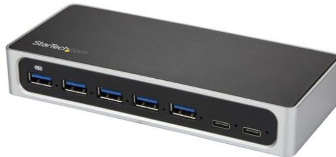
Ce hub USB-C™ transforme le port USB Type-C™ ou port Thunderbolt™ 3 de votre ordinateur portable ou de bureau en quatre ports USB-A standard, un port de charge rapide USB-A et deux ports USB-C. Vous pouvez également étendre la portée de vos appareils USB en utilisant ce hub comme répéteur intermédiaire.
