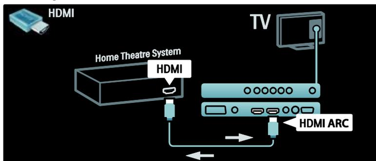
L'opzione HDMI ARC consente di utilizzare la funzione Philips EasyLink per riprodurre l'audio del televisore direttamente su un dispositivo collegato senza un cavo audio digitale aggiuntivo.
