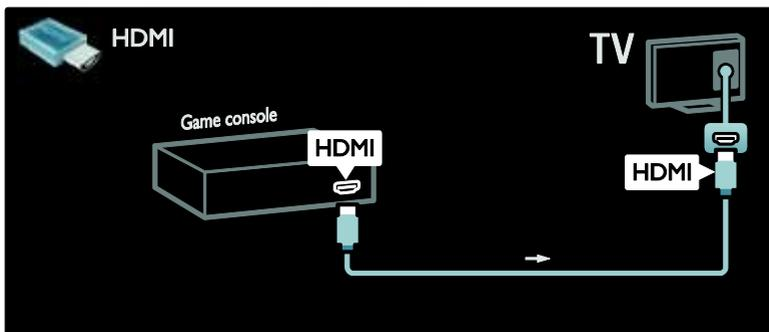
Se non è possibile utilizzare il connettore laterale, utilizzare un cavo HDMI o il cavo EXT2 (YPbPr e audio L/R) per collegare la console di gioco al retro del TV (su alcuni modelli, il cavo EXT2 è contrassegnato come EXT3).
