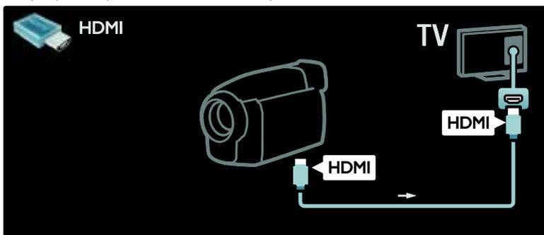
In alternativa, usare un cavo HDMI o component video/audio (YPbPr e Audio L/R) per collegare la videocamera sul retro del TV.
