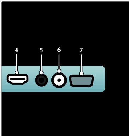
**4.HDMI ARC:** oltre alle classiche funzionalità HDMI, consente di riprodurre l'audio del televisore su un dispositivo compatibile HDMI ARC, come un sistema Home Theater.
