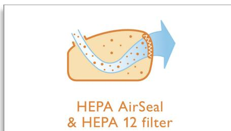
Cet aspirateur a été conçu de telle sorte que tout l'air aspiré passe à travers le filtre lavable HEPA 12 (filtration à 99,5 %) avant d'être évacué. Aucune échappée possible !
