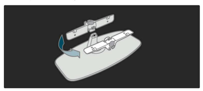
Vuelva a colocar la barra en el soporte y fije el tornillo con la llave Allen.
