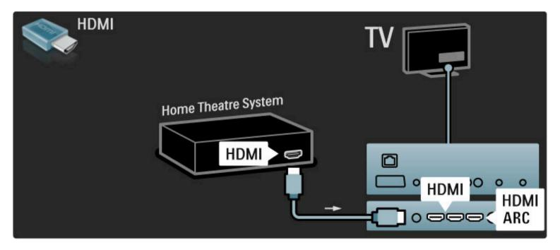
Si no utiliza la conexión HDMI-ARC, utilice también un cable de audio digital (coaxial cinch).
