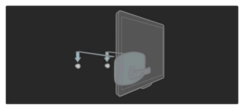
Para nivelar el televisor, tire de la parte inferior del televisor hacia usted moviéndolo sobre los discos.
