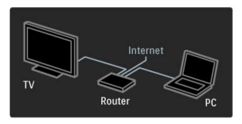
Si desea realizar una conexión mediante cable al router, necesitará un cable de red (Ethernet).
