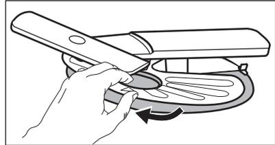
4. Reinigen Sie die Filter.
