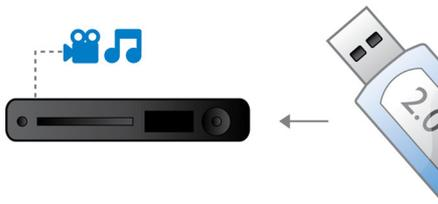
L'USB (Universal Serial Bus) est un protocole permettant de relier facilement des ordinateurs, des périphériques et des équipements électroniques grand public. Les appareils USB ultrarapides ont un taux de transfert de données allant jusqu'à 480 Mbit/s (il était de 12 Mbit/s sur les premiers appareils USB). Avec le port USB 2.0 ultrarapide, vous n'avez qu'à brancher votre appareil USB, sélectionner un film, un titre ou une photo et lancer la lecture.
