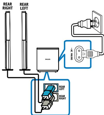
Branchez les adaptateurs des enceintes arrière gauche et droite sur les connecteurs correspondants situés à la base du récepteur sans fil.
