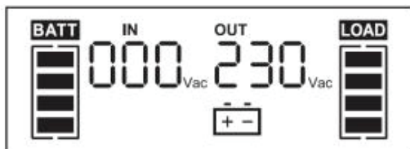
Abb. 11. Display im Batteriemodus.
