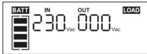
Abb. 12. Display im Batterie ladegerät-Modus.
