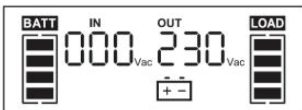
Fig. 11. Display en modo baterías.
