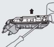
**7** Usuń tylną ściankę modułu zasilającego za pomocą śrubokrętu.
