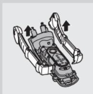
**3** Odvrnite četiri zavrtnja sa prednje strane aparata pomoću šestougaonog imbus ključa i uklonite prednji poklopac kućišta.
