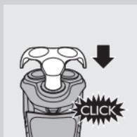
► Nasadte na holicí strojek ochranný kryt, abyste předešli poškození holicích hlav.
