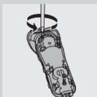
**6** За допомогою викрутки відкрутіть три гвинти в герметичному блоці живлення на задній стороні бритви.
