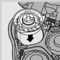
**4** Vyměňte staré holicí hlavy za nové. Umístěte přídržný rámeček zpět do holicí jednotky a otočte pojistku směrem doprava.
