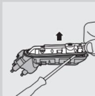
**6** Odvrnite tri zavrtnja u zapečaćenoj jedinici za napajanje sa zadnje strane aparata pomoću odvijača.
