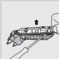
**7** Îndepărtați panoul posterior al unității de alimentare etanșe cu ajutorul unei șurubelnițe.
