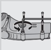
**2** Ostavite aparat za brijanje da radi dok se ne zaustavi, odvrnite dva zavrtnja na komori za prikupljanje dlaka pomoću odvijača i izvadite je.
