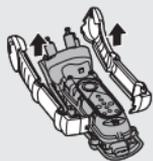
**4** Wyjmij boczne ścianki, odłączając je od szczelnego modułu zasilającego.
