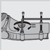
**2** Lăsați aparatul de bărbierit să funcționeze până când se oprește, demontați cele două șuruburi din compartimentul pentru păr și îndepărtați-l cu ajutorul unei șurubelnițe.
