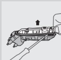
**7** Šroubovákem sejměte zadní kryt vodotěsné napájecí jednotky.
