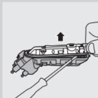
**7** Odvojite stražnju ploču jedinice za napajanje pomoću odvijača.
