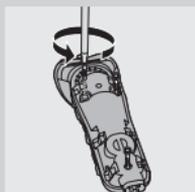
**6** Desfaceți cele trei șuruburi din unitatea de alimentare etanșă aflată în partea posterioară a aparatului de ras cu ajutorul unei șurubelnițe.
