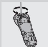
**6** Odšroubujte pomocí šroubováku tři šrouby ve vodotěsné napájecí jednotce na zadní straně přístroje.
