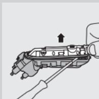
**7** Z izvijačem odstranite hrbtno ploščo napajalne enote.
