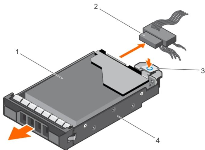
**Figure 30. Retrait d'un support de disque dur câblé**
