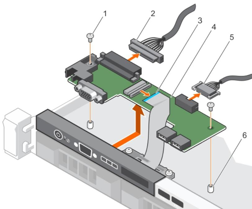
**Figure 95. Retrait de la carte du panneau de commande LCD – châssis à quatre disques durs**
