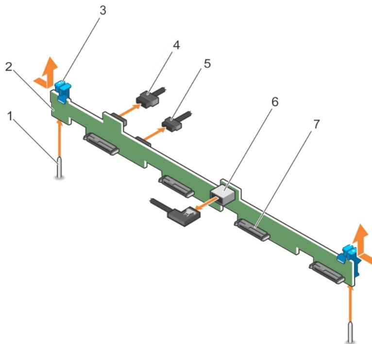
**Figure 84. Retrait du backplane des quatre disques durs de 3,5 pouces ou quatre disques durs de 2,5 pouces SAS/SATA**
