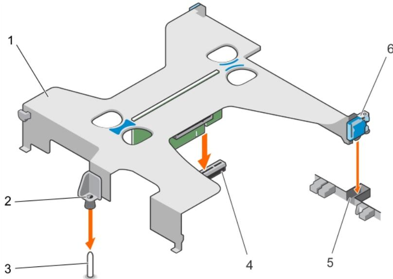
**Figure 56. Installation de la carte de montage pour carte d'extension**
