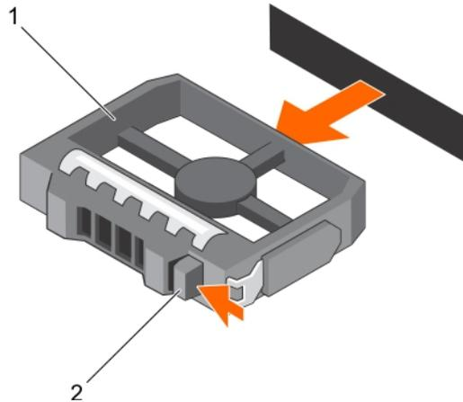
Figure 28. Retrait d'un cache de disque dur 3,5 pouces
