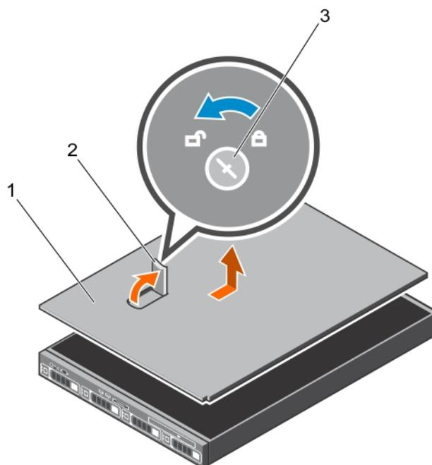
**Figure 14. Retrait du capot du système**
