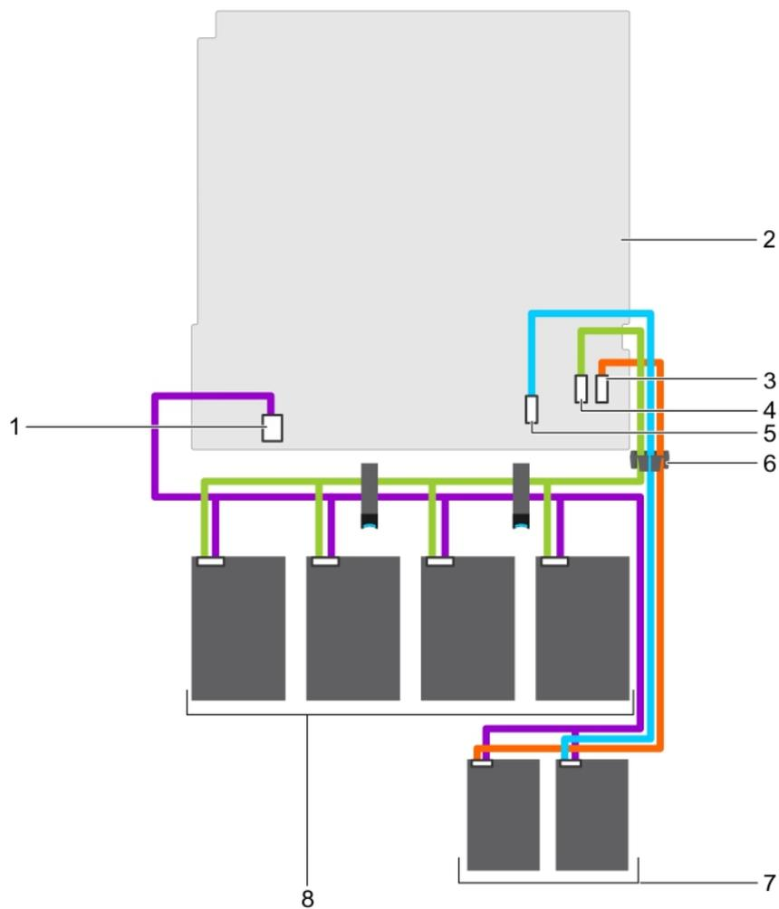
**Figure 90. Schéma de câblage : quatre disques durs câblés de 3,5 pouces câblés et deux disques durs SSD de 1,8 pouce**
