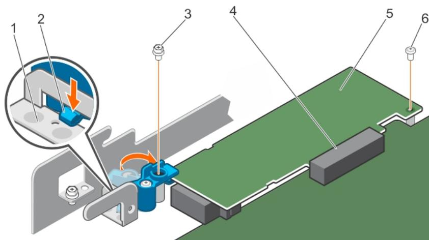
Figure 63. Fermeture du verrou de carte PERC
