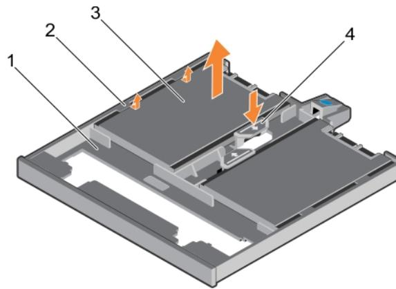
**Figure 37. Retrait des disques SSD de 1,8 pouce du plateau**
