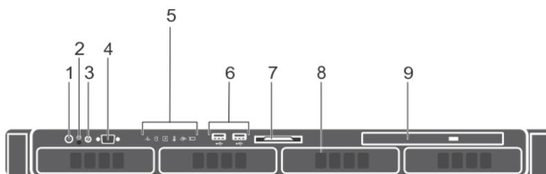
Figure 4. Fonctions et voyants du panneau avant - châssis à quatre disques durs câblés de 3,5 pouces remplaçables à chaud
