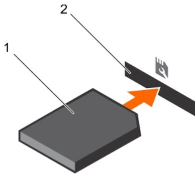
Figure 65. Installation d'une carte SD vFlash en option
