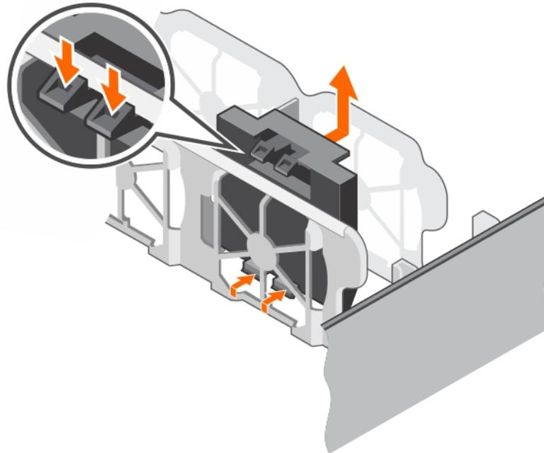
Figure 48. Retrait d'un cache de ventilateur de refroidissement
