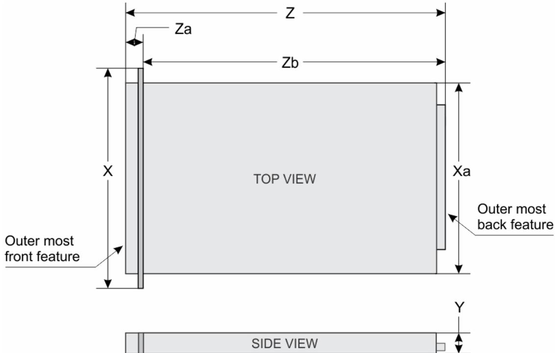
Figure 11. Dimensions du châssis du système PowerEdge R330
