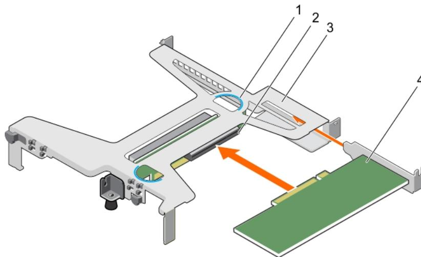
**Figure 58. Installation de la carte d'extension dans la carte de montage pour carte d'extension**
