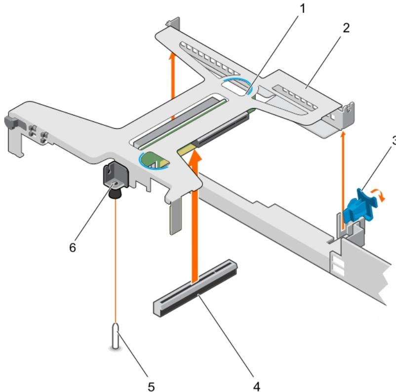
Figure 55. Retrait et installation de la carte de montage pour carte d'extension
