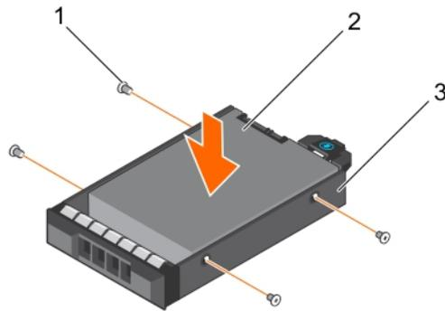
**Figure 33. Installation d'un disque dur câblé dans un support câblé**
