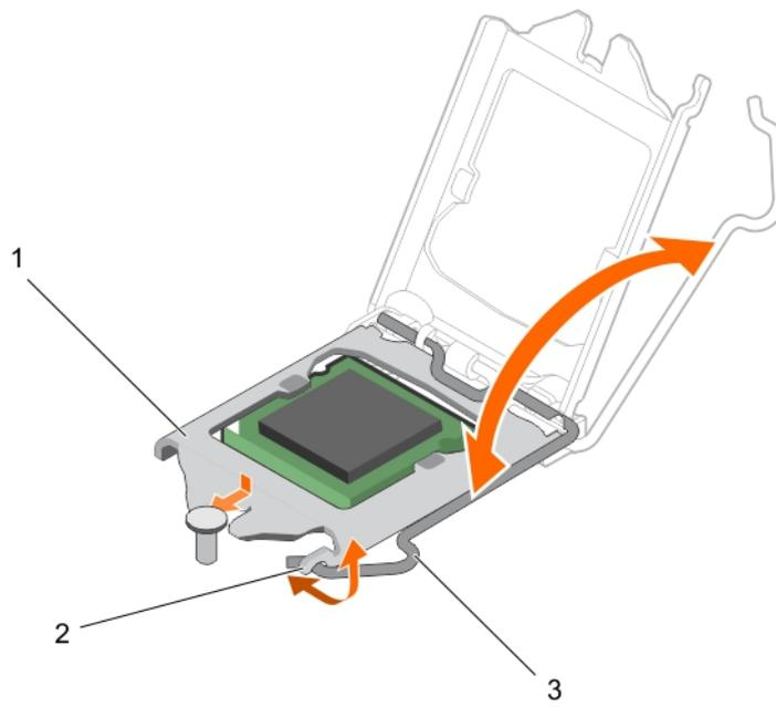
**Figure 73. Ouverture et fermeture du cadre de protection du processeur**
