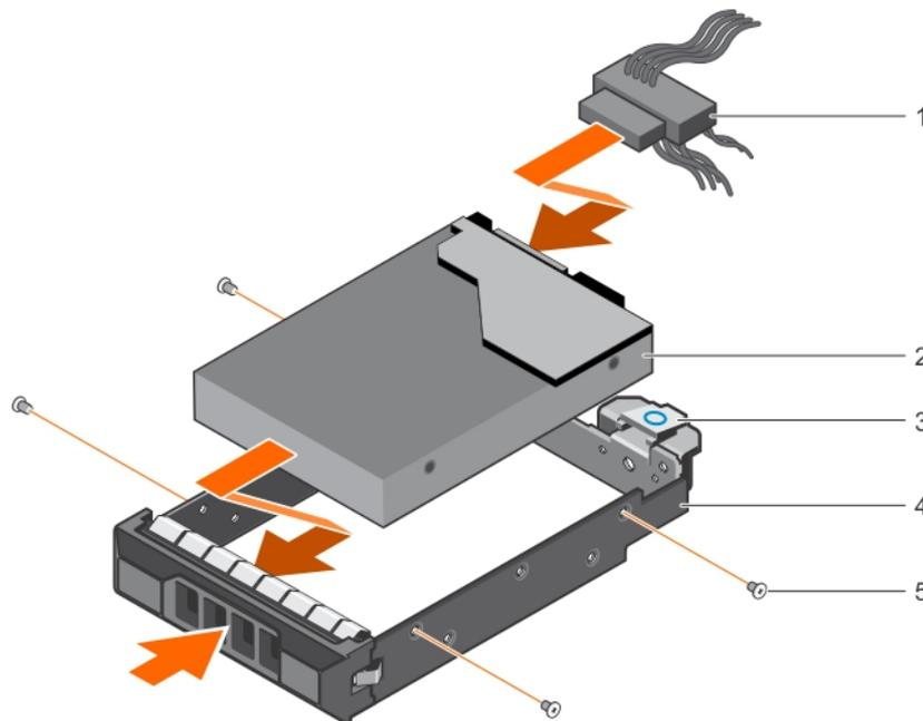
**Figure 31. Installation d'un support de disque dur câblé**
