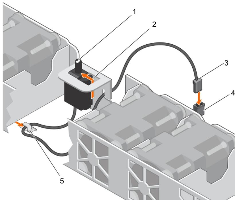
Figure 20. Installation du commutateur d'intrusion
