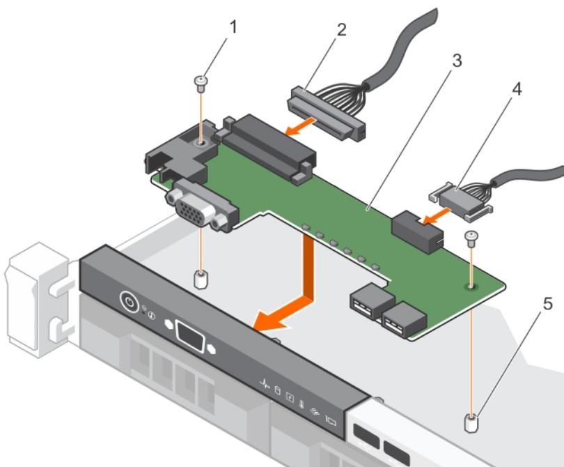
**Figure 101. Installation de la carte du panneau de commande LED – châssis de quatre disques durs câblés**
