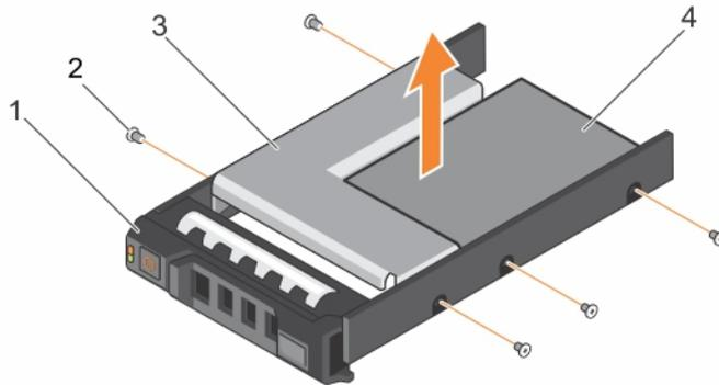
**Figure 42. Retrait d'un adaptateur de disque dur de 3,5 pouces installé dans un support de disque dur.**
