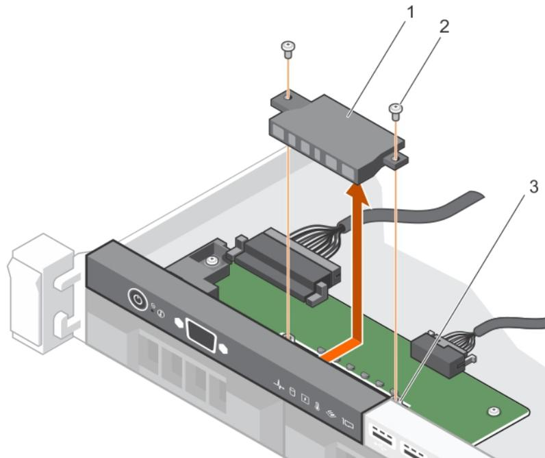
Figure 98. Retrait du module LED – châssis à quatre disques durs câblés
