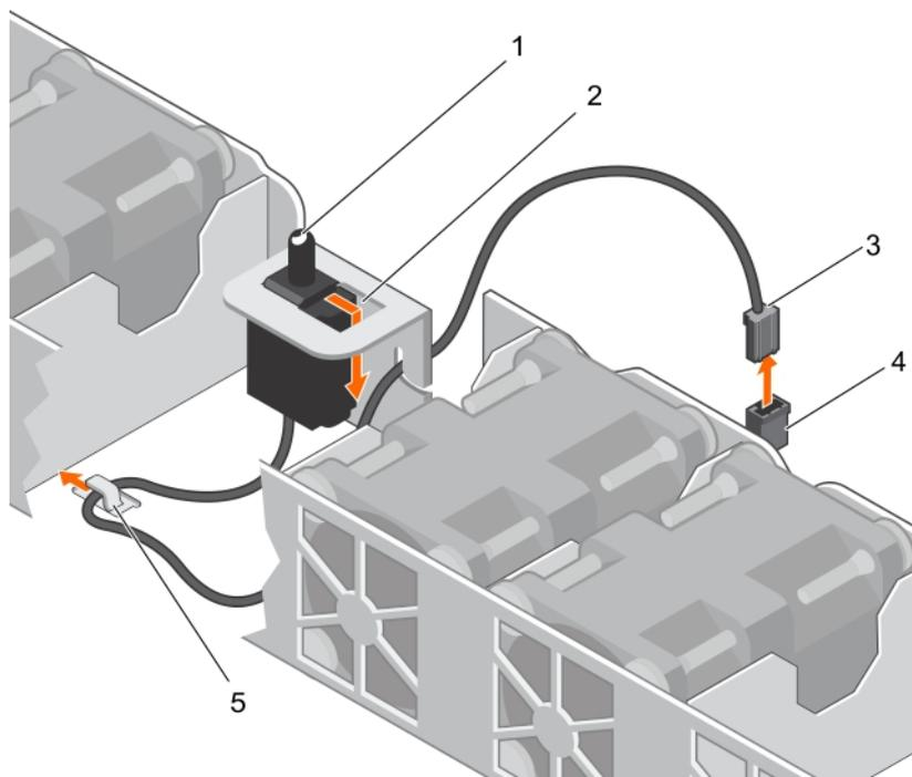
Figure 19. Retrait du commutateur d'intrusion
