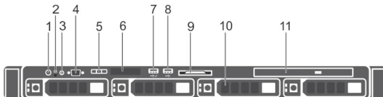
Figure 2. Fonctions et voyants du panneau avant - châssis à disques durs de 3,5 pouces remplaçables à chaud
