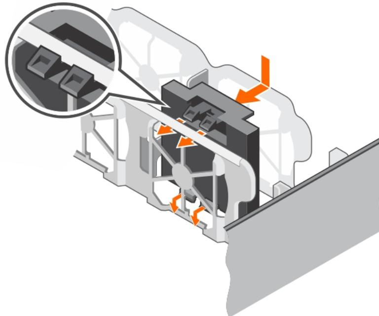
Figure 49. Installation d'un cache de ventilateur de refroidissement
