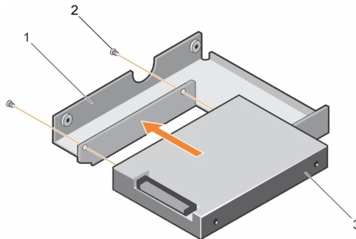
Figure 41. Installation d'un disque dur de 2,5 pouces remplaçable à chaud dans un adaptateur de disque dur de 3,5 pouces
