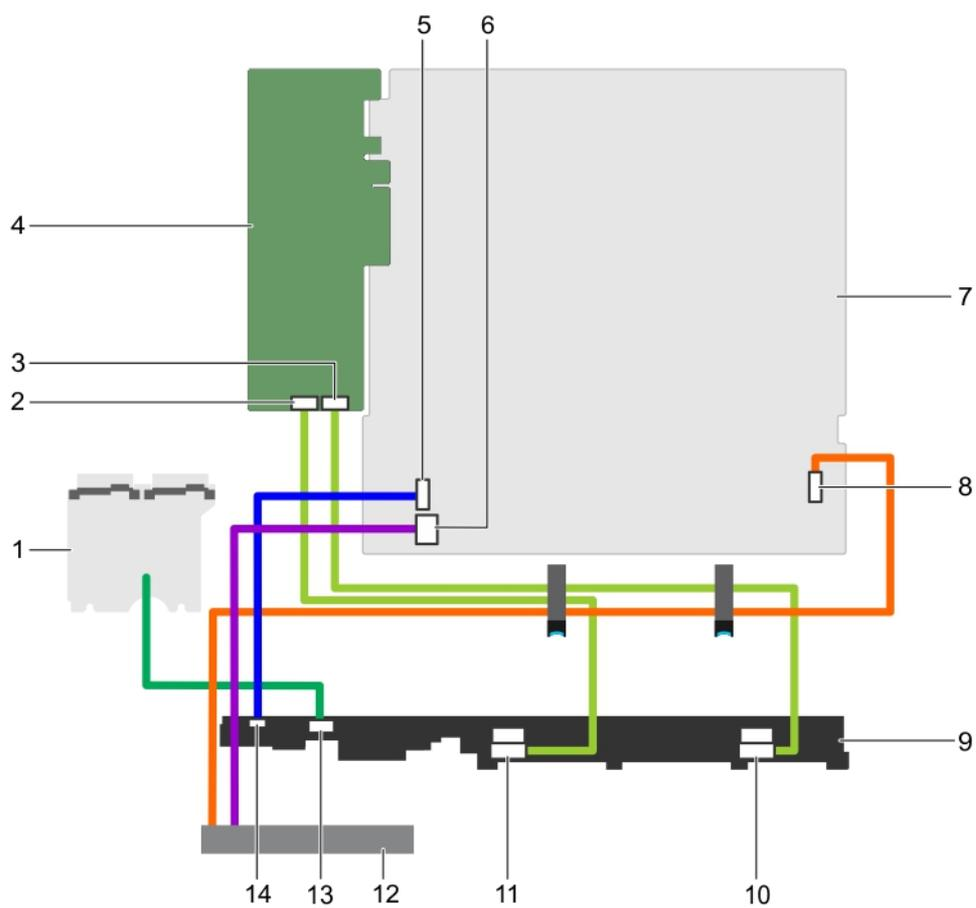
**Figure 87. Schéma de câblage : fond de panier des huit SAS/SATA de 2,5 pouces avec carte PERC**
