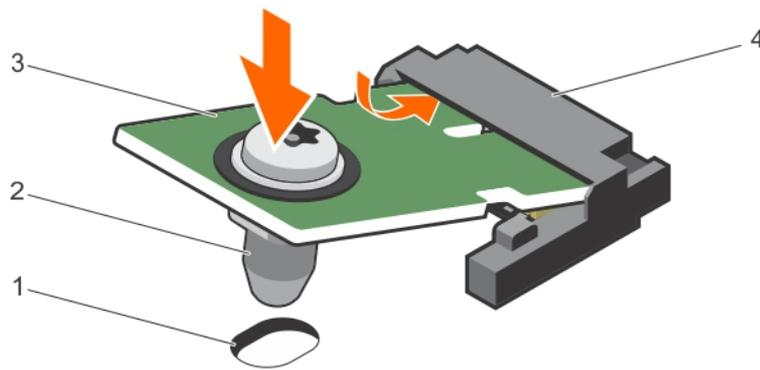
Figure 104. Installer le module TPM
