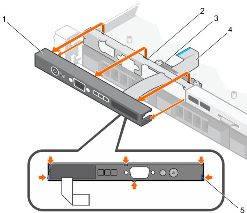
**Figure 94. Retrait du panneau de commande LCD – châssis de quatre disques durs 3,5 pouces remplaçables à chaud**
