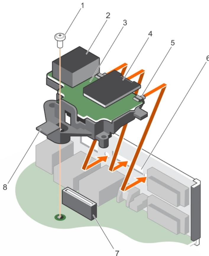
Figure 67. Installation de la carte des ports iDRAC
