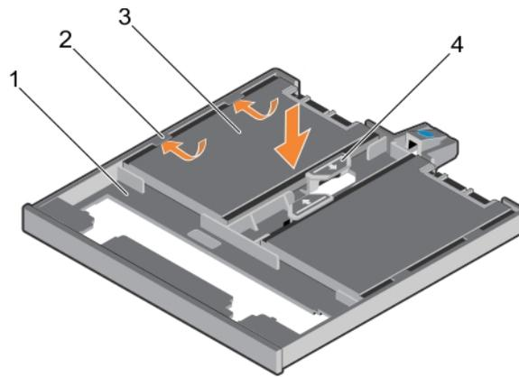
**Figure 38. Installation des disques SSD de 1,8 pouce dans le plateau**
