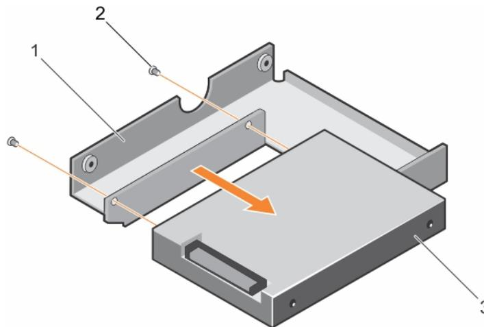
Figure 40. Retrait d'un disque dur 2,5 pouces depuis un adaptateur de disque dur 3,5 pouces
