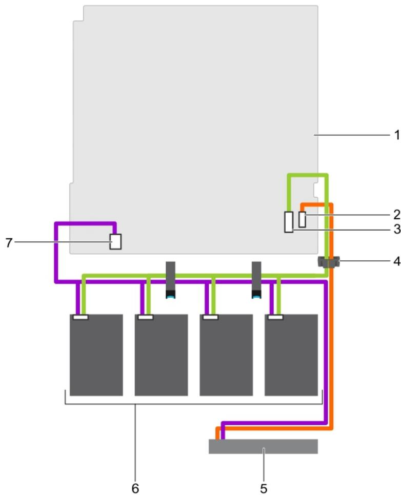
**Figure 88. Schéma de câblage : quatre disques durs câblés de 3,5 pouces**
