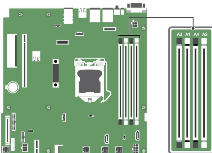
**Figure 23. Emplacements des supports de mémoire sur la carte système**
