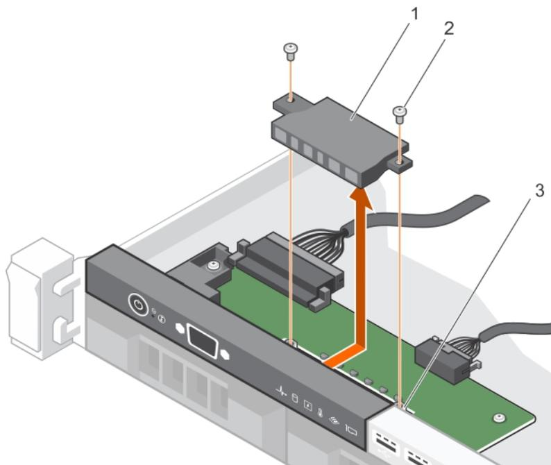
**Figure 100. Installation du module LED – châssis à quatre disques durs câblés**
