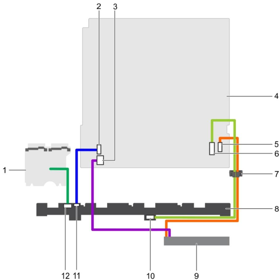
**Figure 85. Schéma de câblage : fond de panier des quatre disques durs de 3,5 pouces ou quatre disques durs SAS/SATA de 2,5 pouces**
