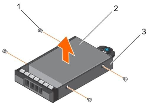
**Figure 32. Retrait d'un disque dur câblé depuis un support connecté par câble**
