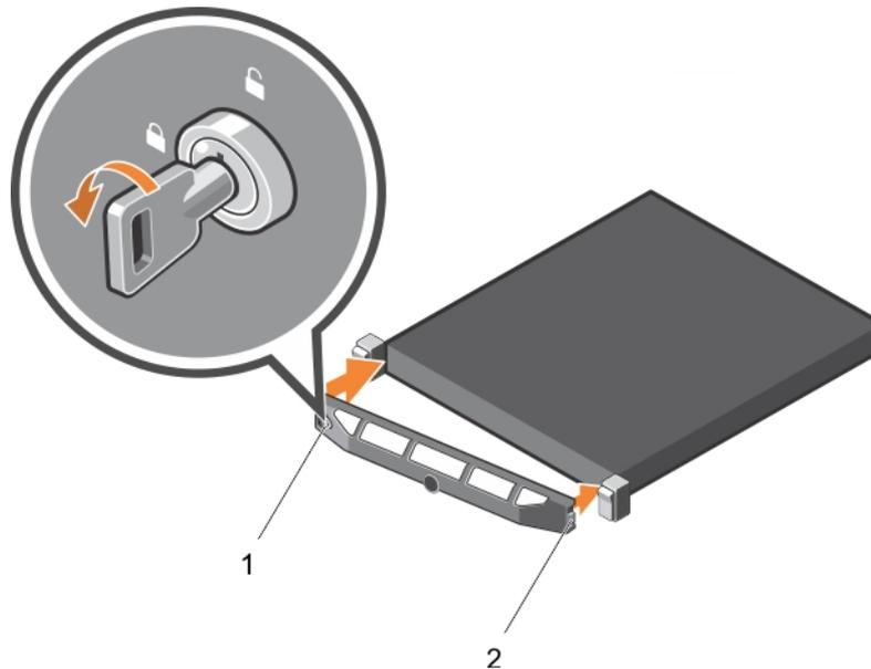
Figure 13. Installation du cadre avant optionnel
