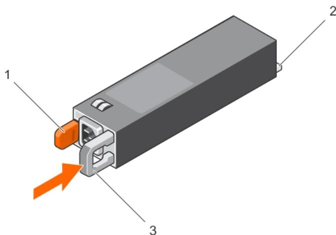
Figure 79. Installation d'un bloc d'alimentation redondant
