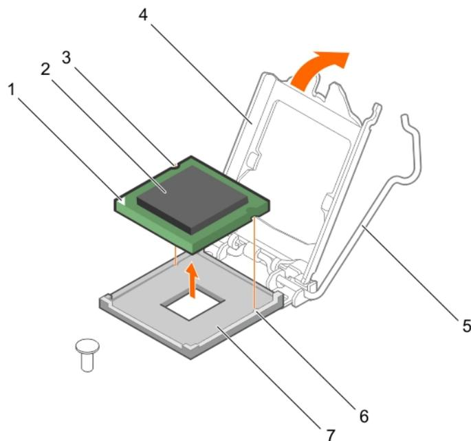
**Figure 74. Retrait et installation d'un processeur**
