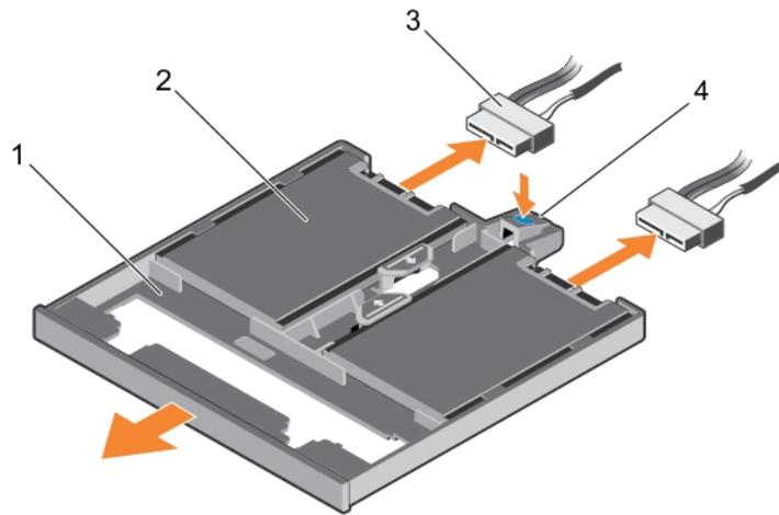
**Figure 36. Retrait du plateau de disque SSD de 1,8 pouce**
