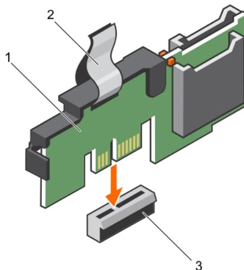
Figure 71. Installation du module SD interne double en option
