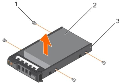
Figure 44. Retrait d'un disque dur remplaçable à chaud installé dans un support de disque dur
