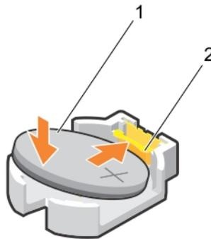
**Figure 83. Installation de la pile du système**
