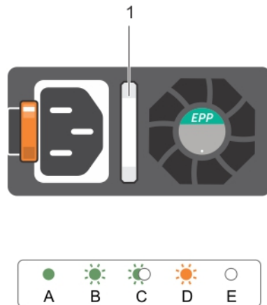
Abbildung 8. Statusanzeige des Wechselstrom-Netzteils
