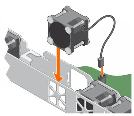
Figure 49. Installing a cooling fan
