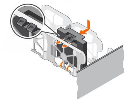
Figure 47. Installing a cooling fan blank
