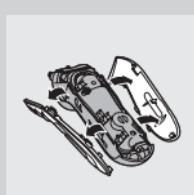
**3** Allentate le due viti poste sul retro del rasoio e rimuovete il pannello posteriore dell'alloggiamento.
