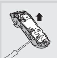
**6** Retire o painel traseiro da unidade de alimentação selada com a ajuda de uma chave de parafusos.
