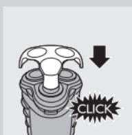
Para evitar deterioros en los cabezales de afeitado, coloque la tapa protectora en la afeitadora.
