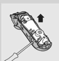
**6** Verwijder het achterpaneel van de waterdichte voedingsunit met een schroevendraaier.
