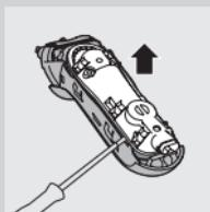
**6** Rimuovete il pannello posteriore del gruppo di alimentazione per mezzo di un giravite.
