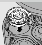
**4** Extraiga los cabezales de afeitado y coloque los nuevos en la unidad de afeitado. Coloque de nuevo el marco de retención en la unidad de afeitado y gire el cierre de seguridad en el sentido de las agujas del reloj.
