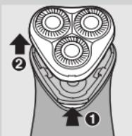
**1** Tắt máy, rút phích cắm khỏi ổ điện và kéo đầu cắm ra khỏi máy cạo râu khi pin đã được sạc đầy.
