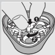
**7 將電鬍刀刀頭裝回電鬍刀組上。將固定架裝回電鬍刀組 (1)，並以順時針方向轉動刮鬍轉盤 (2)。**
