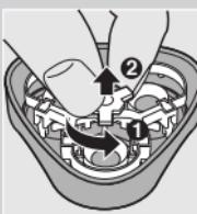
**3** 以逆時針方向轉動轉盤 (1)，將固定架拆下 (2)。
