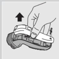
Jangan menghubungkan lagi alat cukur ke listrik setelah baterai dikeluarkan.
