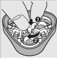
**5** 將固定架裝回電鬍刀組 (1)，並以順時針方向轉動刮鬍轉盤 (2)。
